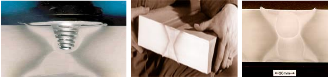
Şekil 3.7. 75 mm Kalınlığındaki AA6082T6 Alaşımının Kaynağında Whorl™ Takımını Kullanılması, Kaynağın Bitmiş Hali ve Kaynak Dikişinin Görüntüsü.
