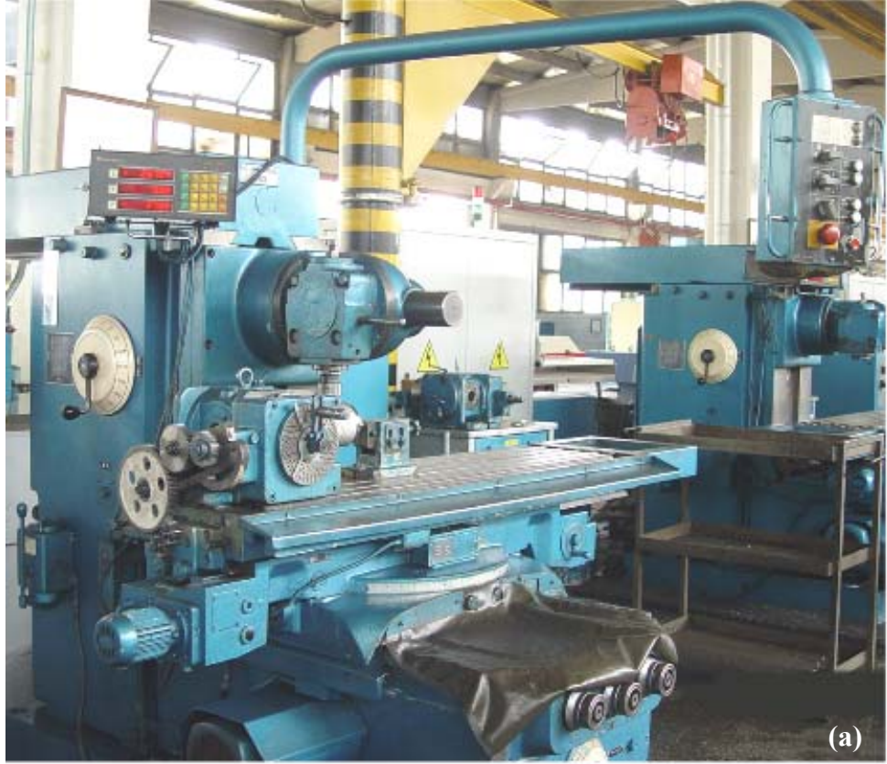
Şekil 4.1. (a) SKK Kaynağında Kullanılan NC Freze Tezgahı ve Üzerindeki Kaynak Aparatları (Perspektif Görünüş).
