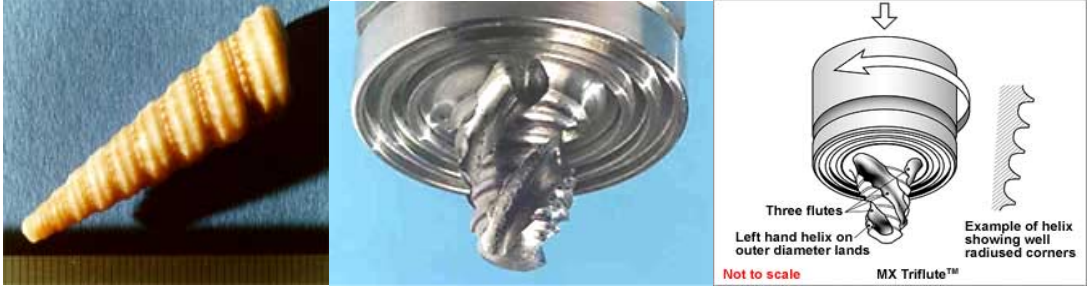
Şekil 3.8. MX Triflute™ Pimin Esin Kaynağı Deniz Kabuklarıdır. MX Triflute™ Serisi Pimin Resim ve Şematik Çalışma Şekli.
