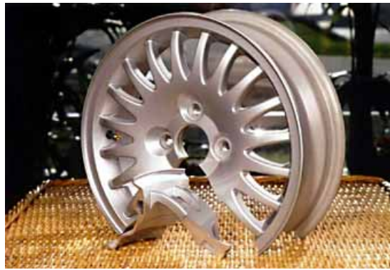
Şekil 3.25. SKK ile Birleştirilen Al-Alaşımı Prototip Otomobil Jantı.
