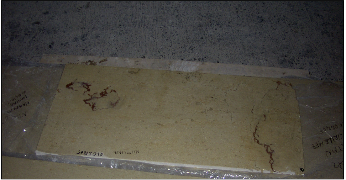
Şekil 2.5. Dolgusu Yapılmış Olan Plakaların Üzeri Naylon İle Örtülüp İstiflenerek Kürlemeye Bırakılması
