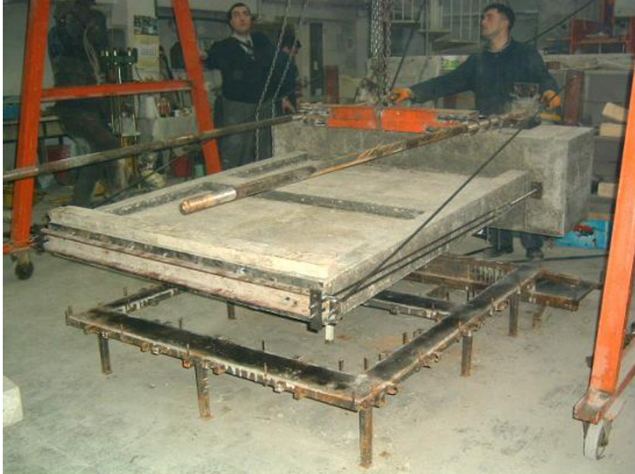
Resim 2.5. Deney elemanının kalıptan kaldırılışı
