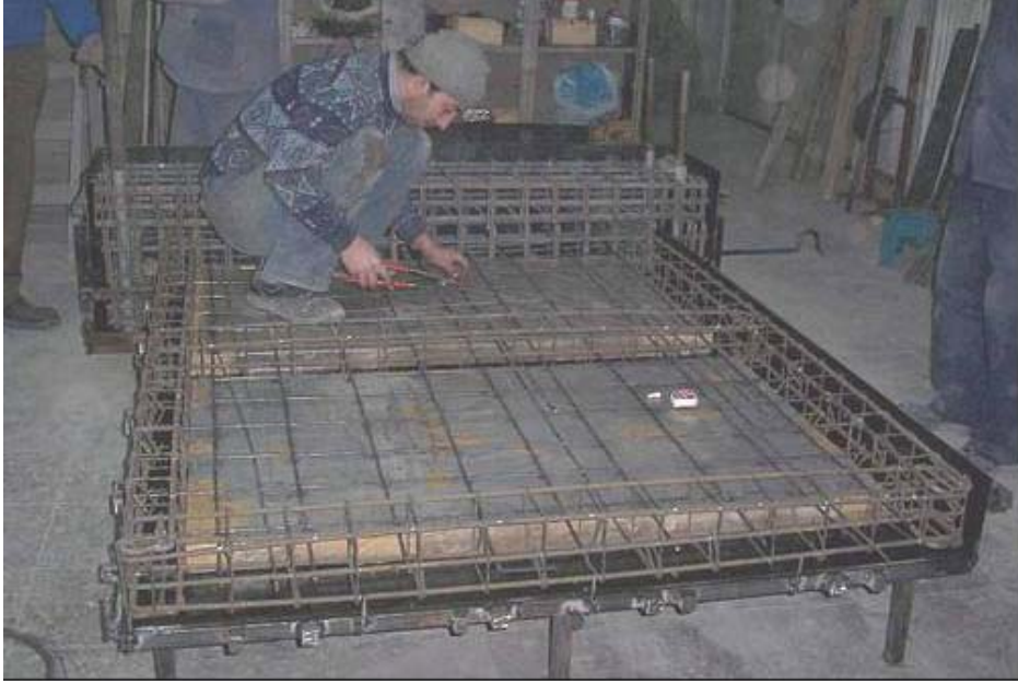
Resim 2.3. Bir döküm dolgu duvarlı deney elemanında donatı hazırlanışı
