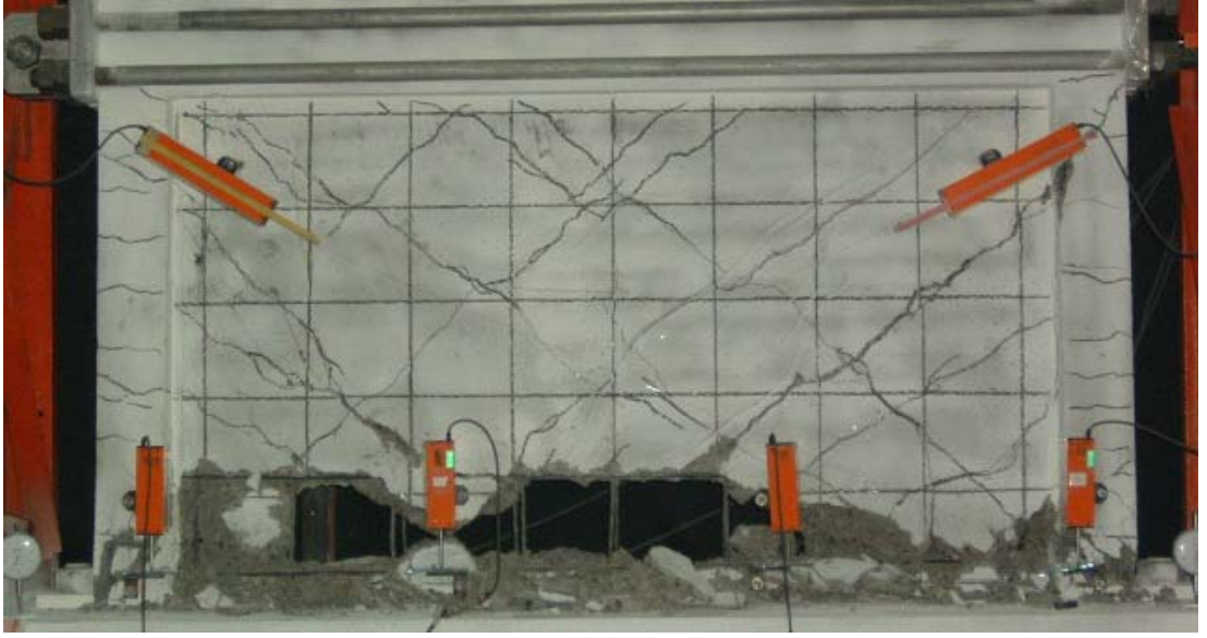
Resim 3.3. Gçmede birinci kat dolgu duvarı, Deney Elemanı-2
