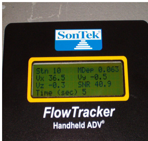
Şekil 3.5. (a) Lcd Gösterge Paneli (b) 3 Boyutlu Hız Ölçen Başlıklar
