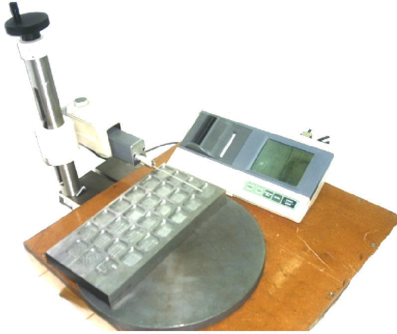
Şekil F.1 Deney numunesi ve Mitutoyo SurfTest SJ – 402 yüzey pürüzlülük ölçüm cihazı.
