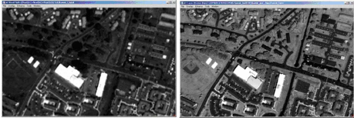
Şekil 2.8 Yoğunluk bandıyla pankromatik bant arasındaki parlaklık farkı (A: Yoğunluk Bandı, B: Pankromatik Bant)
