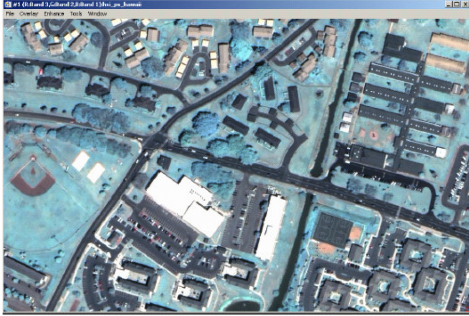
Şekil 2.7 HIS algoritmasıyla üretilmiş pan-sharp QuickBird görüntüsü
