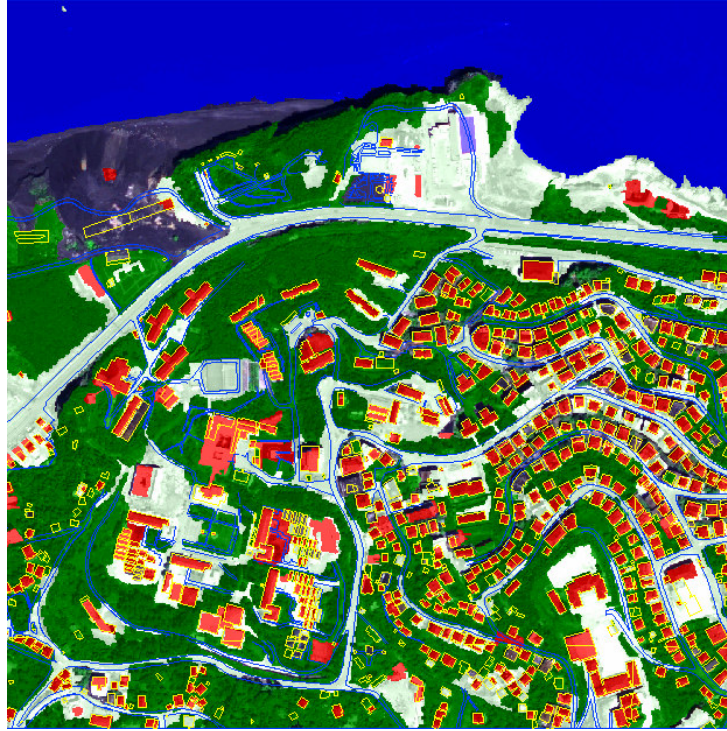
Şekil 5.16 Nesne-tabanlı sınıflandırma sonucu ile vektör haritanın çakıştırılmış hali (Sarı çizgiler vektör haritada bulunan binaları, mavi çizgiler de yolları ifade etmektedir)
