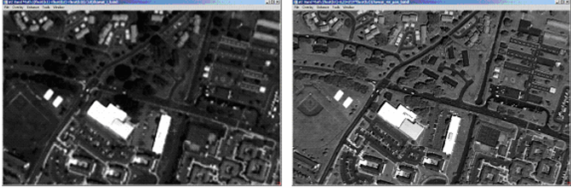
Şekil 2.9 Yoğunluk bandıyla birlikte görünür pankromatik bant (A: Yoğunluk Bandı, B: Görünür Pankromatik Bant)
