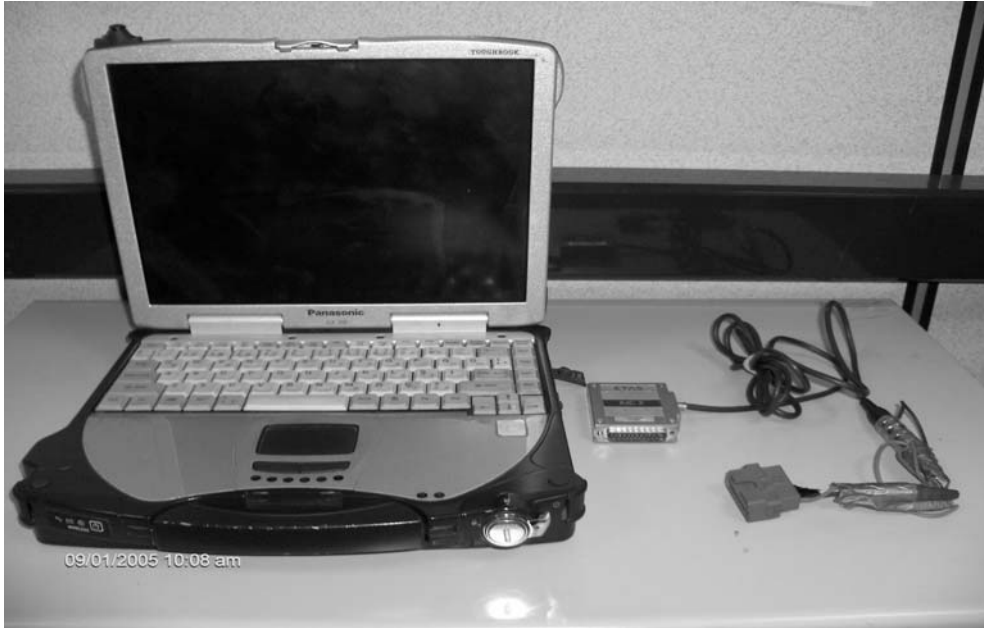
Resim 5.4_EKÜ'ye bağlanmada kullanılan bilgisayar ve bağlantı cihazı (KIC _ 1.3 bakınız)
