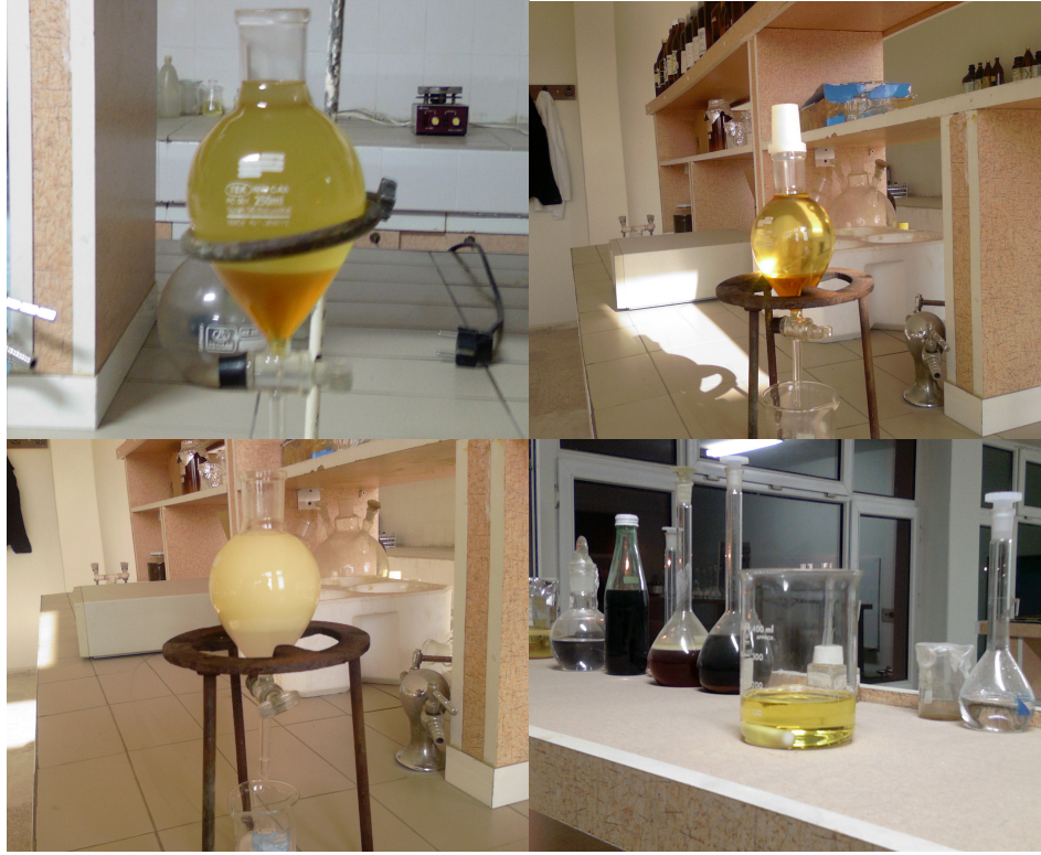
Şekil 3.2. Biodizel üretiminde reaksiyon tamamlandıktan hemen sonra (üst sol), sekiz saatlik dinlendirmeden sonra (üst sağ), yıkama işlemi esnasında (alt sol) ve kurutma işleminin ardından elde edilmiş biodizel (alt sağ) için oluşan görüntüler.
