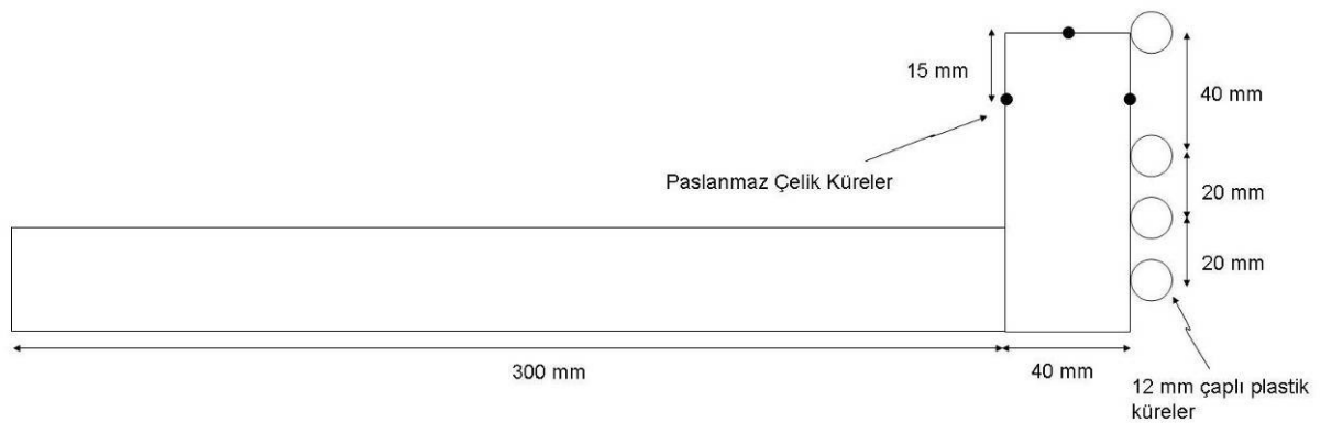
Şekil 3.4 : Sistemin hata payını ölçmek için kullanılan pleksi-glas parçaların çizimi
