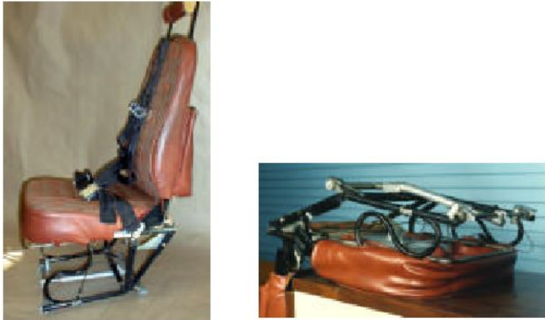
Şekil 1.5 Test Öncesi ve Sonrası Fiziksel Koltuk
