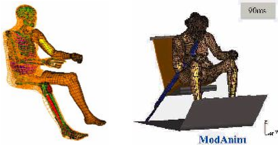
Şekil 1.2 Radioss™ ile Yaratılmış Sonlu Elemanlar Modeli
