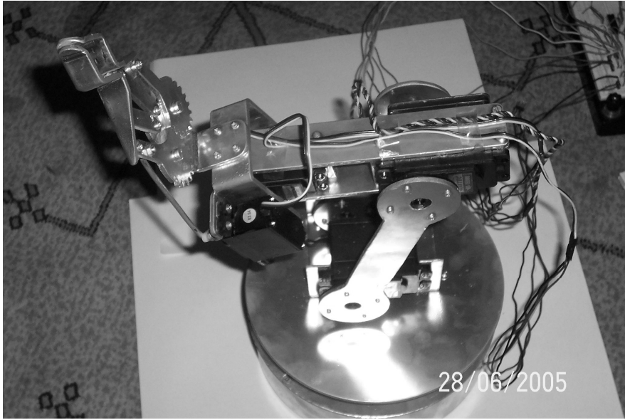
Resim 4.17. Robot kolunun tüm parçalarının montaj edildikten sonraki hali
