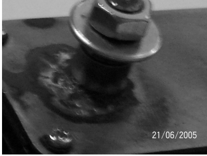
Resim 4.15. Saç parçası üzerine kaynatılmış demir çubuk ve parçaları
