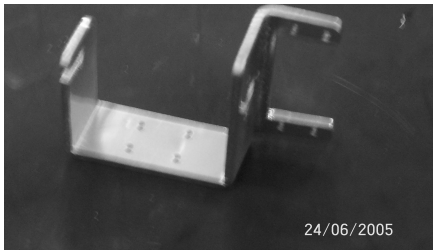
Resim 4.8. Robot kolunun bilek kısmını oluşturan parça
