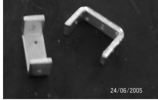
Resim 4.7. Kol bölümünde motorları sıkıştırmak için kullanılan parçalar
