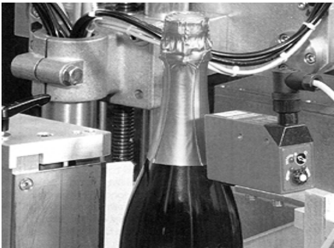
Resim 1.2. Şampanya şişelerinin doğru renkte bantla kaplanıp kaplanmadığının kontrolü (4)
