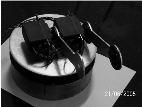
Resim 4.14. Omuz motorlarının montaj edilmiş hali
