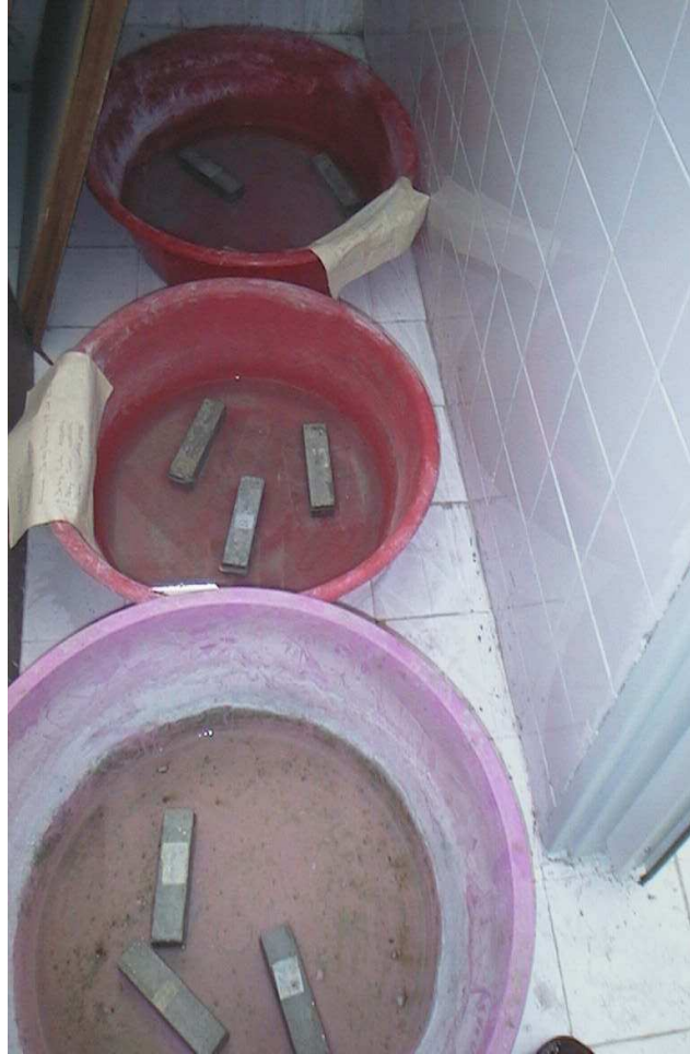
Fotoğraf 6. Suda, NaCl ve MgSO 4 Çözeltilerinde Bekletilen Numuneler
