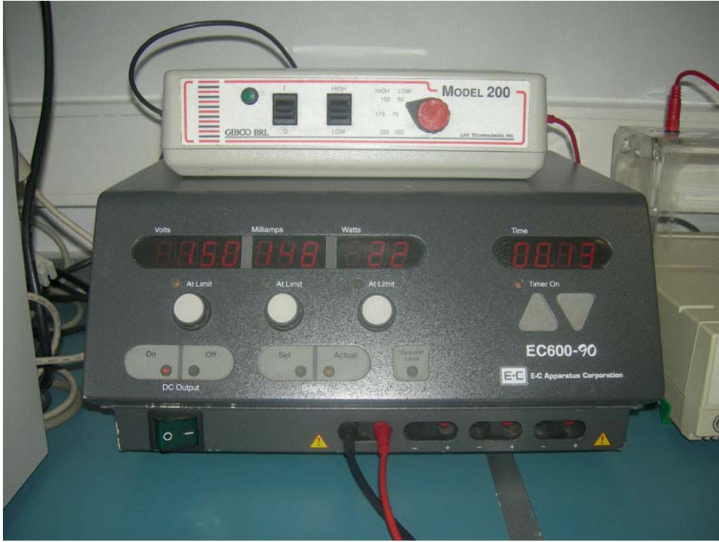
Resim 9: Güç kaynağı (EC Apparatus Corp.EC 600-90) ve Yatay elektroforez.
