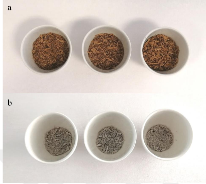
Şekil 3.12. Kül fırını aşamaları. a. Yakılmamış numune, b. Yakılmış numune
