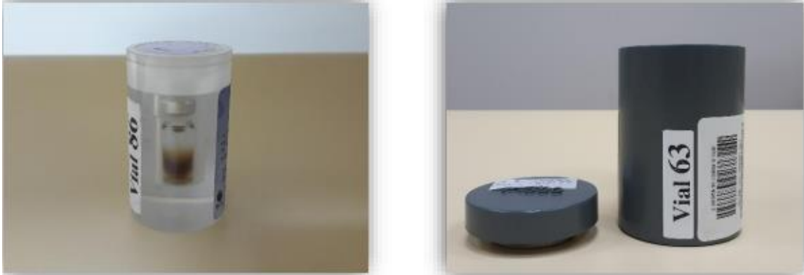
Şekil 3-1: TheraSphere ^{90}\text{Y} Cam MikroKüreleri Viali (solda) Vialin kurşun zırhı (sağda).
