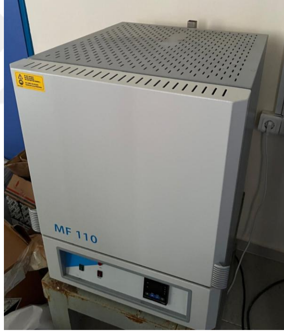
Şekil 3.14: Yüksek sıcaklık deneyinde kullanılan kül fırın
