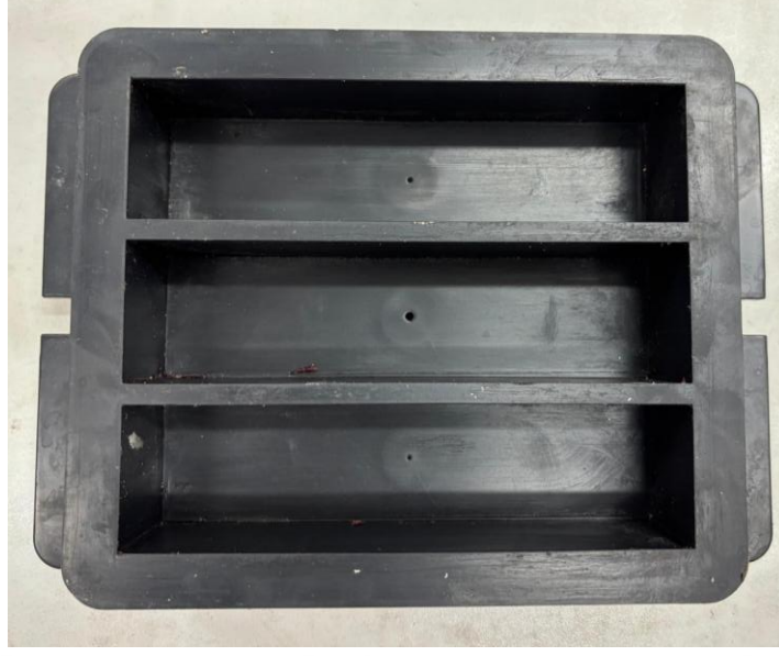
Şekil 3.6: 40x40x160 mm ebatındaki kalıplar
