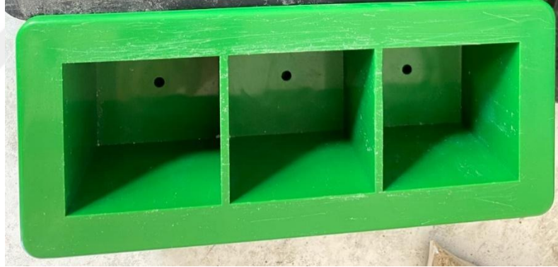
Şekil 3.5: 50x50x50 mm ebatındaki kalıplar
