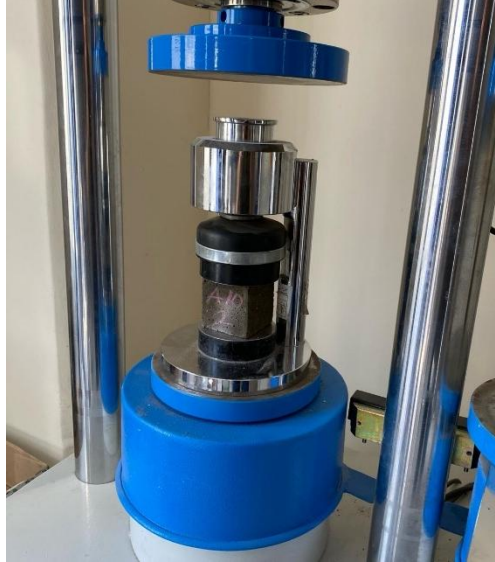
Şekil 3.7: Küp numunelerin basınç dayanımının belirlenmesi için kullanılan kırma başlığı
