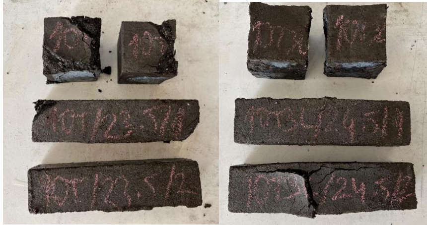
Şekil 4.86: 10T ve 10T3L serisine 2 ay MgSO 4 çözeltisi etkisi
