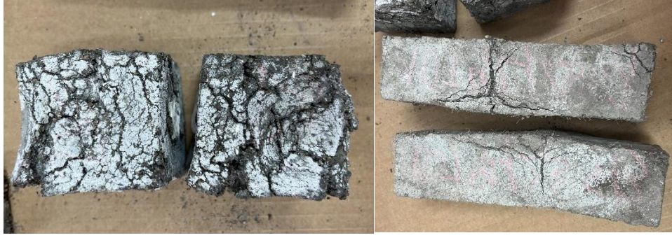
Şekil 4.89: 10T9L serisine 3 ay MgSO_4 çözeltisi etkisi
