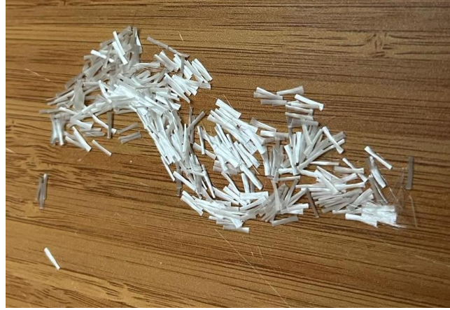
Şekil 3.4: Çalışma kapsamında kullanılan mikrofiber lif
