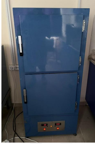
Şekil 3.13: Deneylerde kullanılan etüv
