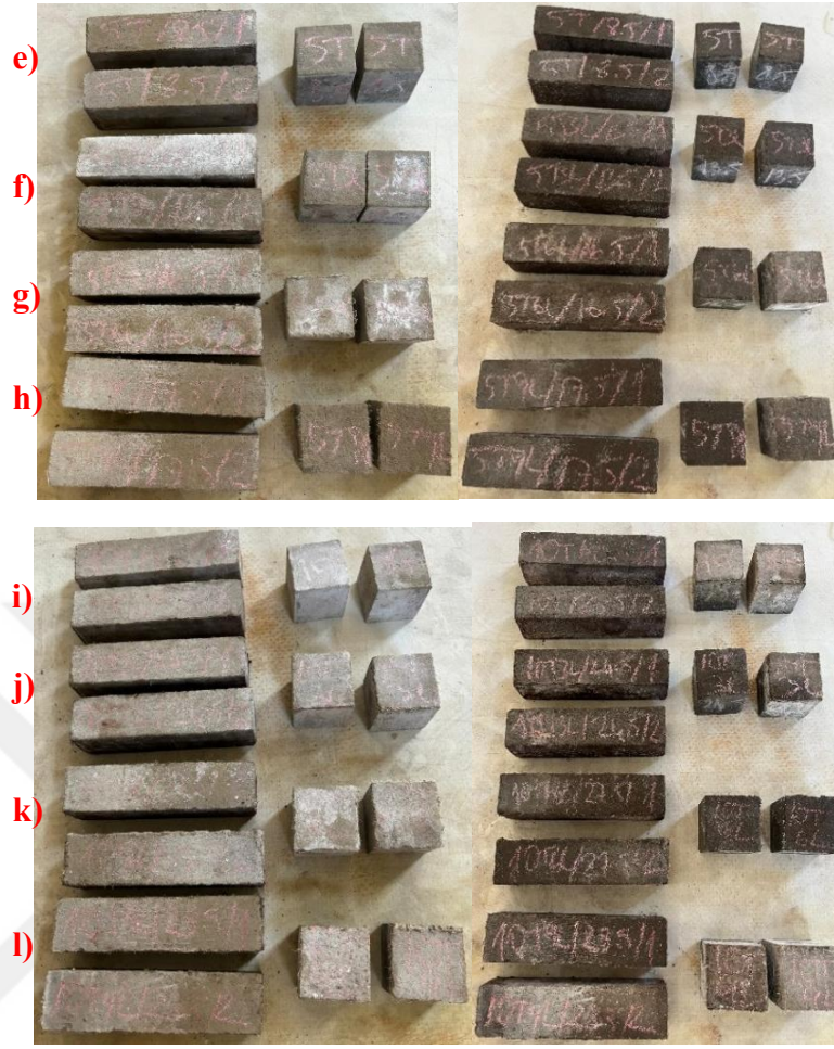
Şekil 4.55 (devam): Donma-çözülme öncesi ve sonrası numunelerin durumu a)K b)K3L c)K6L d)K9L e)5T f)5T3L g)5T6L h)5T9L i)10T j)10T3L k)10T6 l)10T9L serisi
