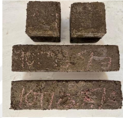
Şekil 4.90: 10T serisine 3 ay Na_2SO_4 çözeltisi etkisi
