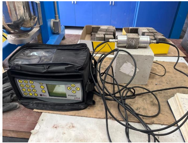
Şekil 3.12: Ultrases geiş hızı ölçüm cihazı
