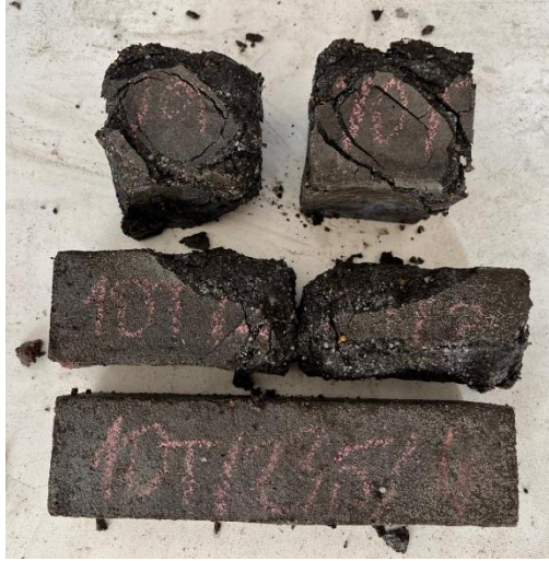
Şekil 4.88: 10T serisine 3 ay \text{MgSO}_4 çözeltisi etkisi
