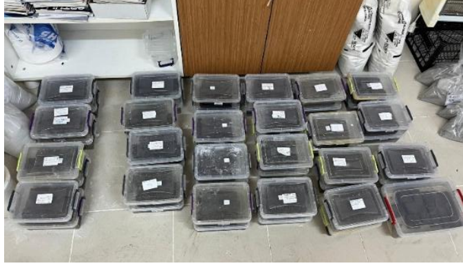
Şekil 3.16: Sülfat etkisindeki numuneler
