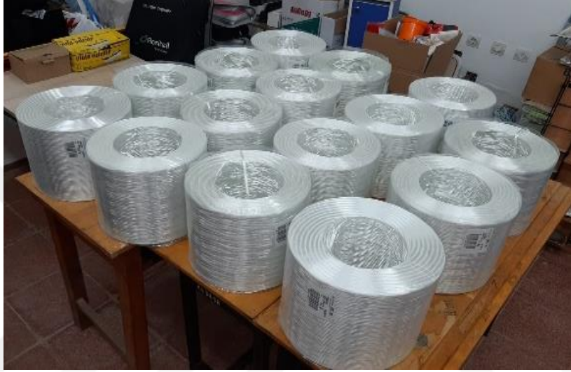
Şekil 5.1: Tek uçlu cam elyaf fitil ürünler
