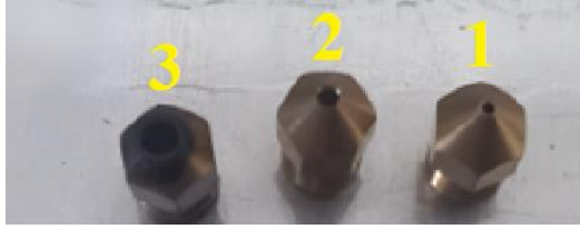
Şekil 5.11: Kaynaklı birleştirmede kullanılan nozullar
