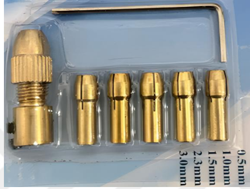
Şekil 5.3: Beş farklı maksimum ölçüye sahip çap ayarlı nozul uçları
