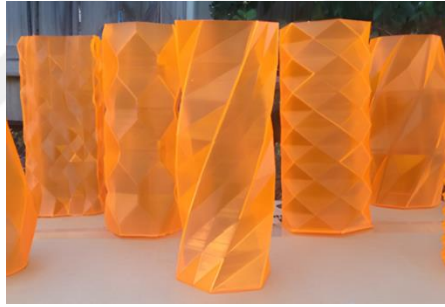
Şekil 3.6: PETG kullanılarak üretilen 3D parça örneği
