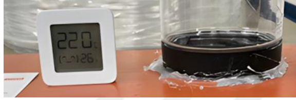
Şekil 5.4: Ortam sıcaklığının ölçümü (dijital termometre)
