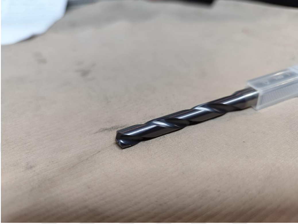
Şekil 2.1: Tez çalışmasında kullanılan karbür alaşımlı kesici takım.
