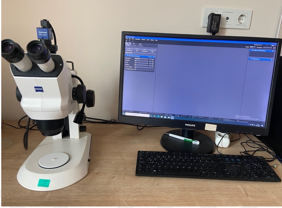
Resim 3.19 Başarısızlık tiplerinin belirlendiği stereomikroskop ve bilgisayar düzeneği
