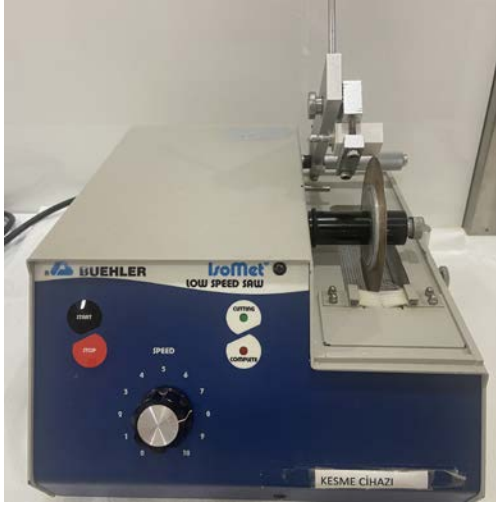
Resim 3.2 Isomet hassas kesme cihazı
