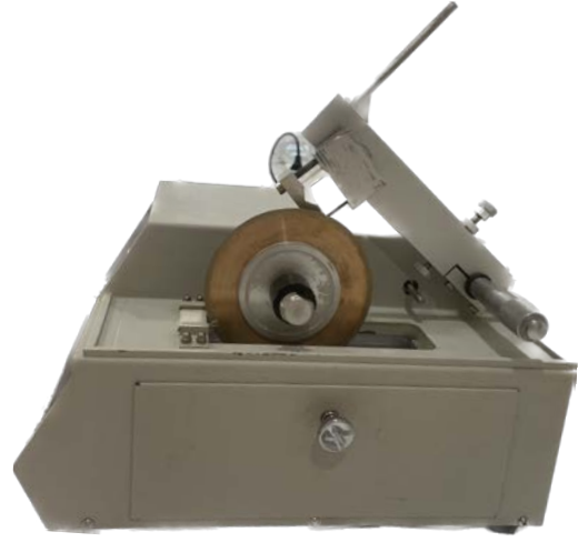
Resim 3.2 Isomet hassas kesme cihazı
