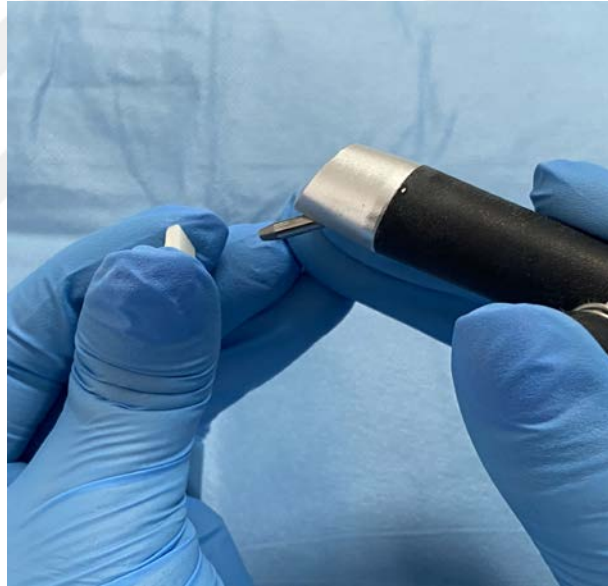
Resim 3.5 Zirkonya örneklere Cojet'in uygulanması
