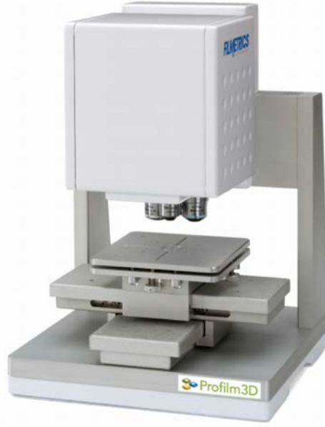
Resim 3.10 Profilometre cihazı ile yüzey pürüzlülüğü ölçümü
