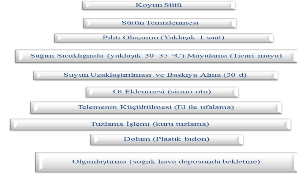
Şekil 3.1. Yöresel Siirt otlu peyniri akım şeması
