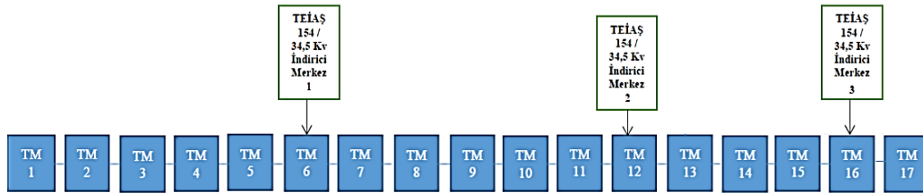
Şekil 4.4 M7 hattı orta gerilim elektrifikasyonunun diyagramı
