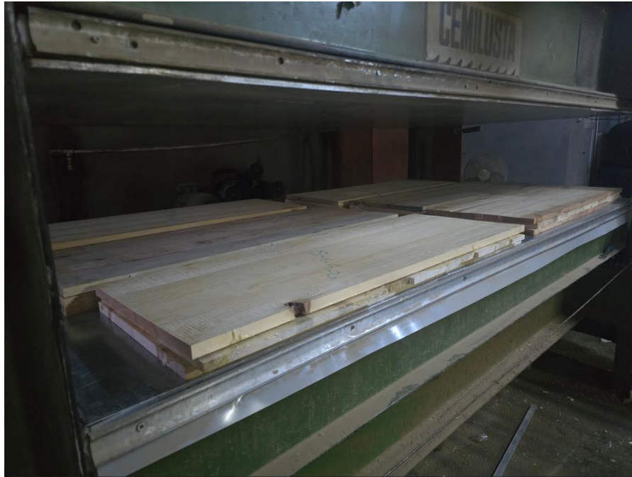
Şekil 3.3: 54 x 400 x 1100 mm ÇLK'ların preslenmesi.
