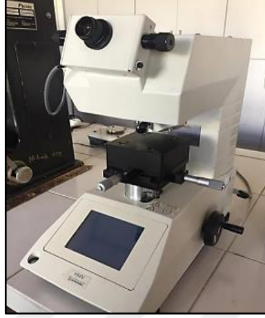
Şekil 5. 3. Buehler Micromet 5103 mikro sertlik ölçüm cihazı.
