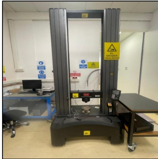
Şekil 5. 5. Instron marka 5982 model çekme test cihazının görseli.
