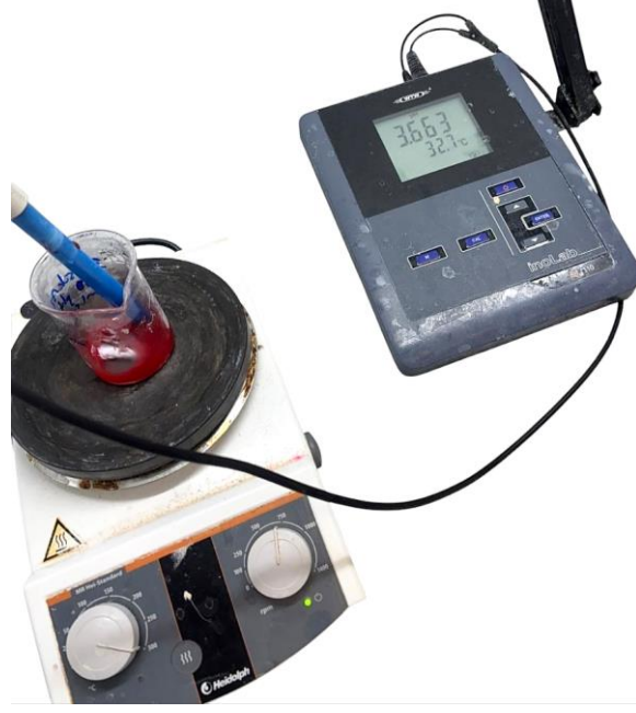
Şekil 2.10. Yumuşak tablet formunun pH metre kullanılarak gerçekleştirilen karakterizasyon analizi
