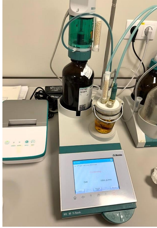
Şekil 2.8. Yumuşak tablet formunun nem cihazında gerçekleştirilen karakterizasyon analizi
