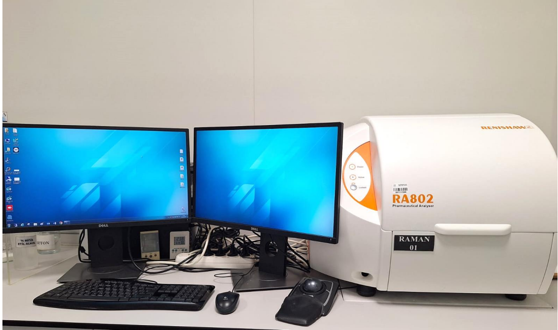
Şekil 2.4. Liyofilizatör cihazında kurutulmuş melatonin numunesine, RAMAN cihazında gerçekleştirilen karakterizasyon analizi
