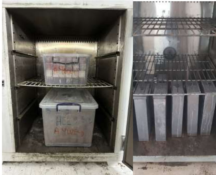
Şekil 22. Dayanım ve ASR numunelerine çözelti içerisinde ısıtılma işlemi
