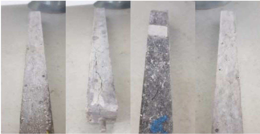
Şekil 51. 210 gün sonunda numunelerde oluşan çatlaklar
