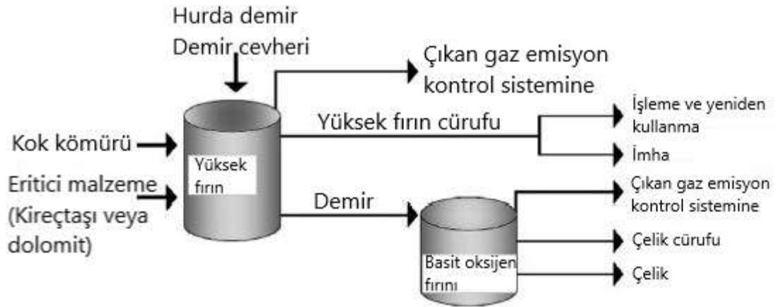
Şekil 9. Cüruf üretim süreci
