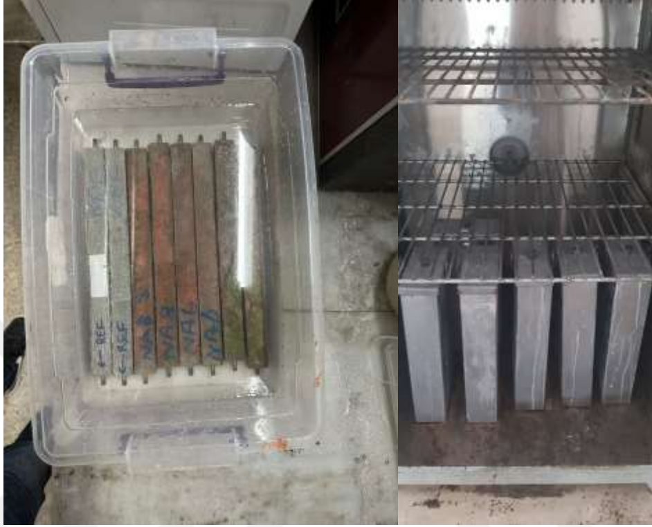
Şekil 32. Harç çubuklarının saklama kaplarında ve numune kaplarında kürlenmesi
