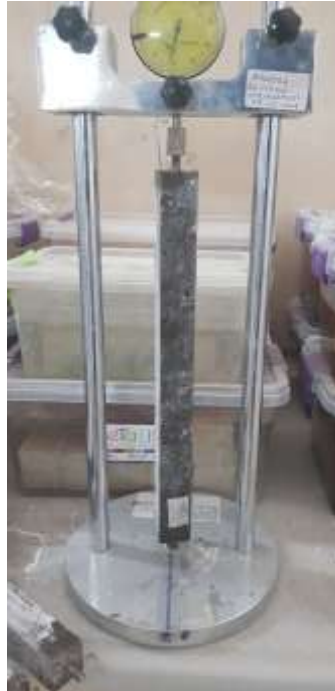
Şekil 33. Harç çubuklarının boyca uzamalarının komparatör yardımıyla ölçümü
