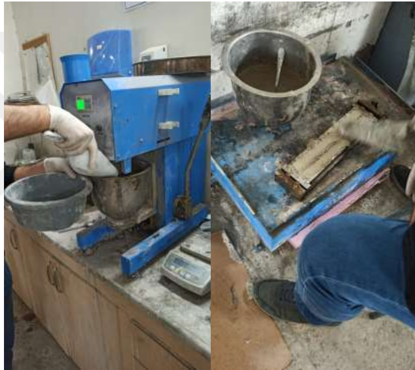
Şekil 30. ASR harç numunelerinin hazırlanması
