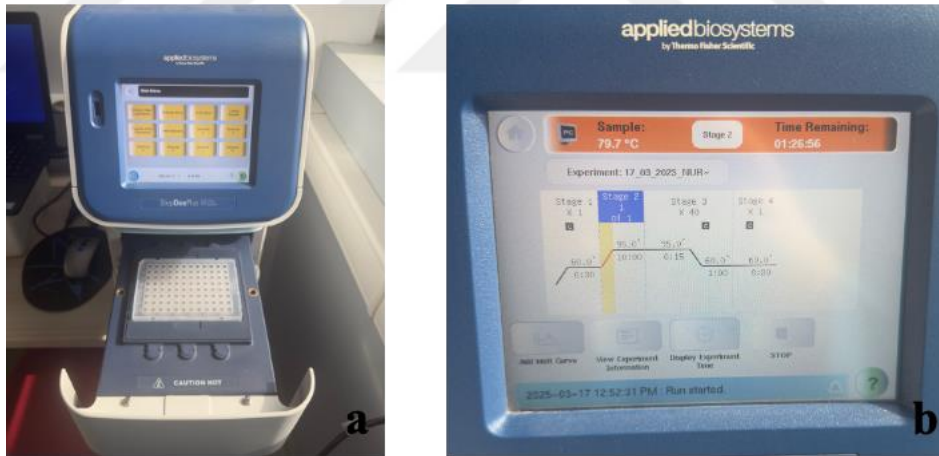
Şekil 14. a) Örneklerin ve kontrollerin bulunduğu plakanın StepOnePlus RT-PCR cihazına yerleştirilmesi b) RT-PCR döngüsü
