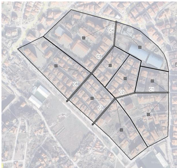
Resim 5.36. Kanal Yerleşimi (EPA-SWMM)
