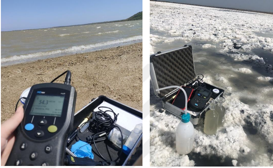
Şekil 3. Gökçeada Tuz Gölü Lagünü'nde arazi çalışması sırasında su örnekleme ve yerinde fizikokimyasal parametre ölçümlerinin gerçekleştirilmesi.
