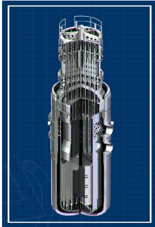
Şekil 3.1 VVER-1200 (AES-2006) reaktörü basınç kabı kesiti [11]
