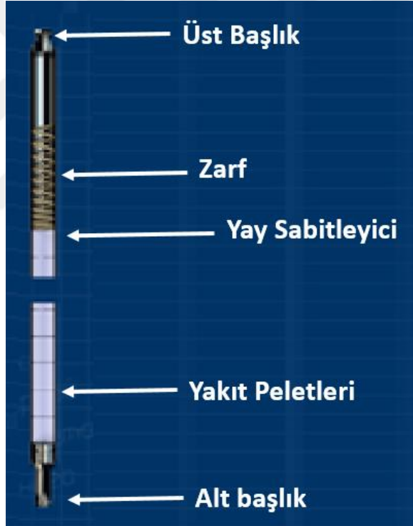
Şekil 3.3 VVER-1200 (AES-2006) yakıt çubuğu kesiti [11]
