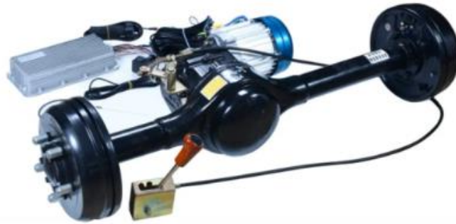
Şekil 3.1. Elektrikli araçlar için motor ve aks seti sistemi.
