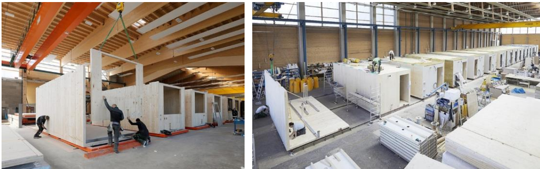
Şekil 3.13 Dolu panel modüllerin üretimi [178], [179]
