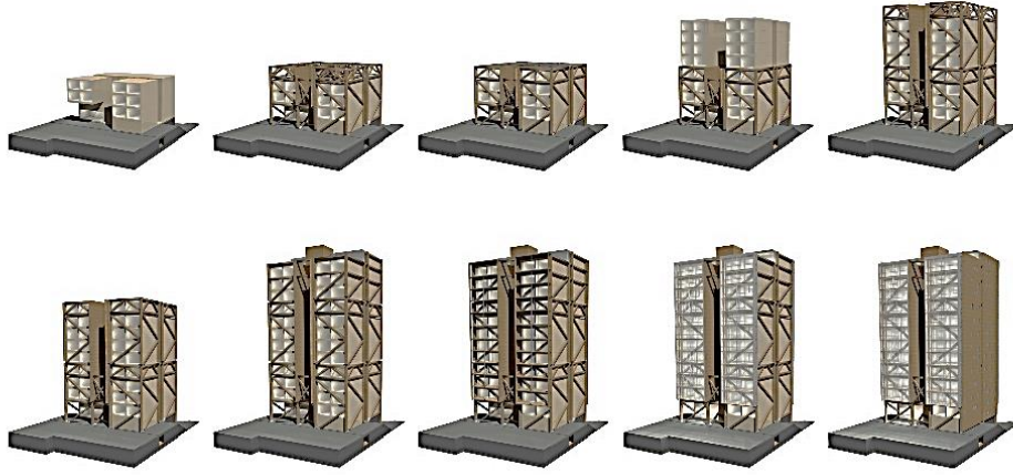
Şekil 3.3 Treet binasının montaj aşamaları [152]
