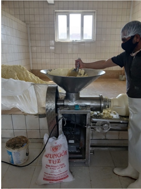
Şekil 3.3: Tulum peynirinin dolum ve depolama işlemi
