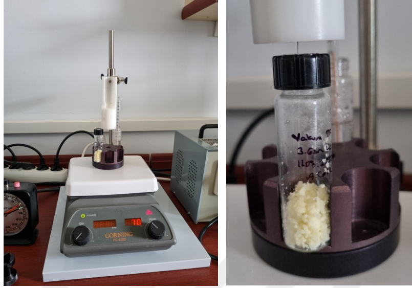
Şekil 3.6: Uçucu bileşen analizi için peynir örneklerinden uçucuların SPME fiberi ile absorbe edilmesi
