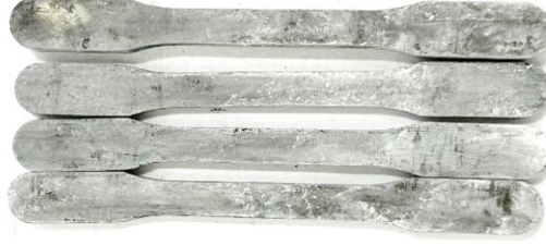
Şekil 4.4. ASTM E8/E8M standardına göre üretilen çekme testi numunesi.
