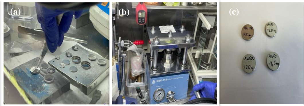
Şekil 3.6 a) Pil bileşenlerinin sıra ile birleştirilmesi, b) Jeton pilin hidrolik sistemde kapatılması, c) Kapatma işleminden sonra üretilen CR2032 düğme pil görüntüsü.
