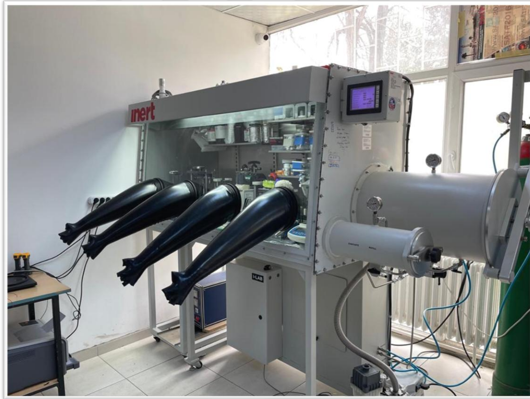
Őekil 3.4 Pil hucreslerini birleřtirme iřleminde kullanılan yksek saflıktaki argon gazı ieren Glove-box cihazı.
