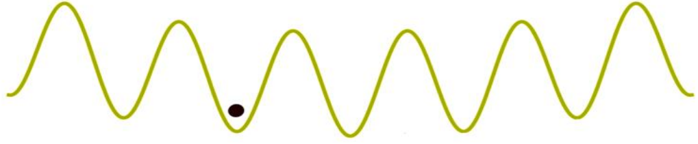
Şekil 3.1: Kristal yapıdaki elektronların davranışını incelemek için kullanılan sıkı bağlanma modeli.
