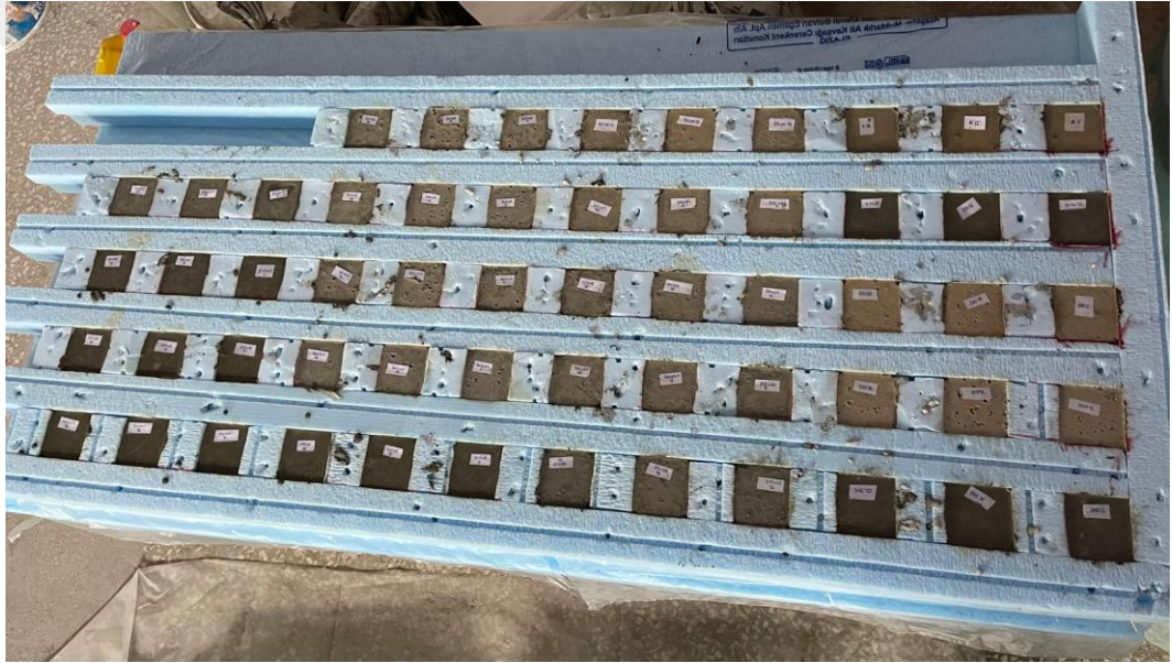
Şekil 4.8. KYH'lerin kalıplara yerleştirilmesi
