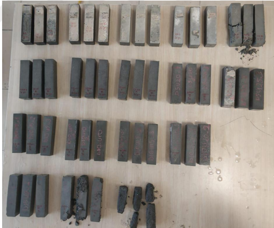
Şekil 4.16. Donma-çözülme döngülerine tabi tutulan numunelerin son durumu
