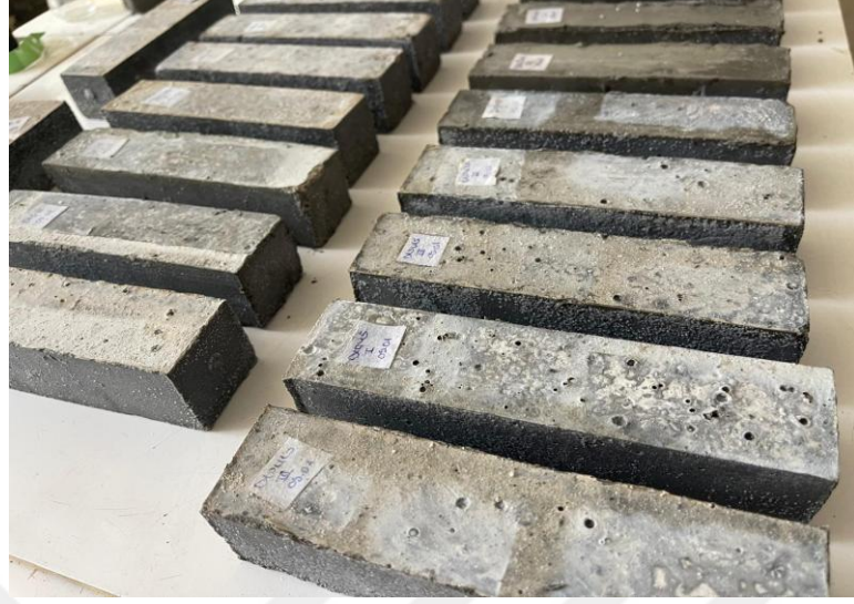
Şekil 4.18. Sülfat çözeltisinden çıkarılan numunelerin görünümü
