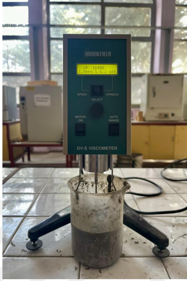
Şekil 4.7. Brookfield DV-E model viskozimetre cihazı
