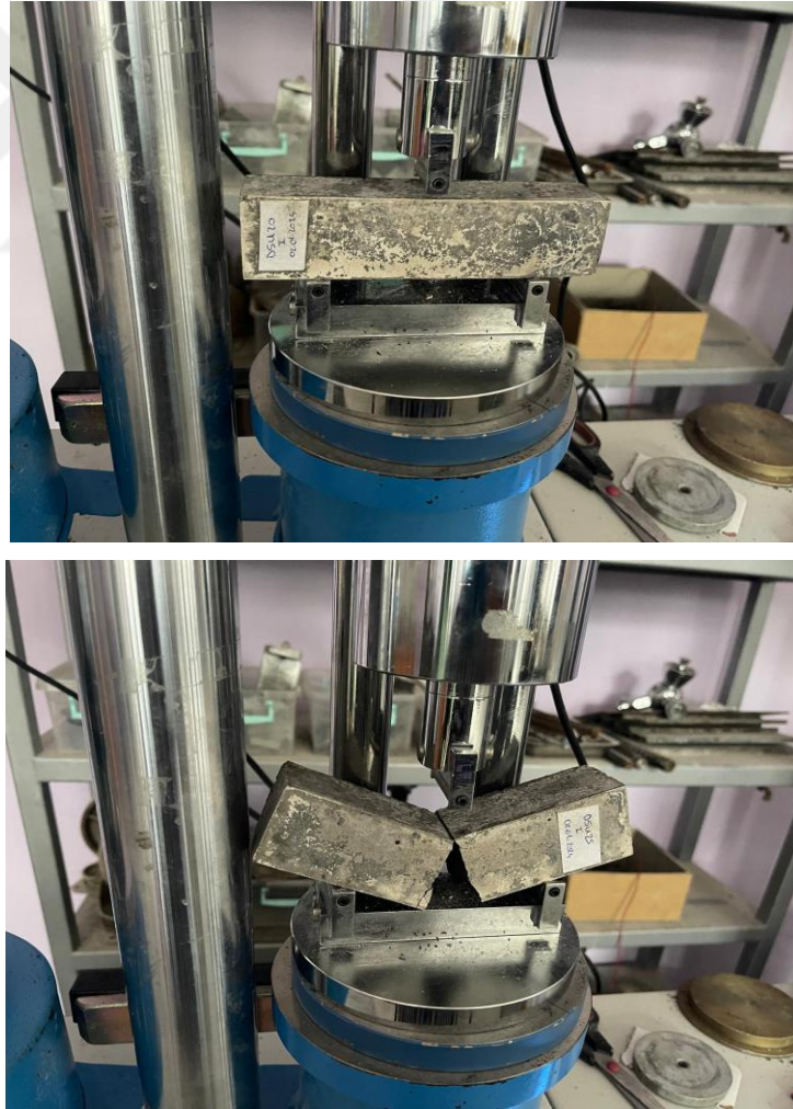
Şekil 4.11. Üç noktalı eğilme testi
