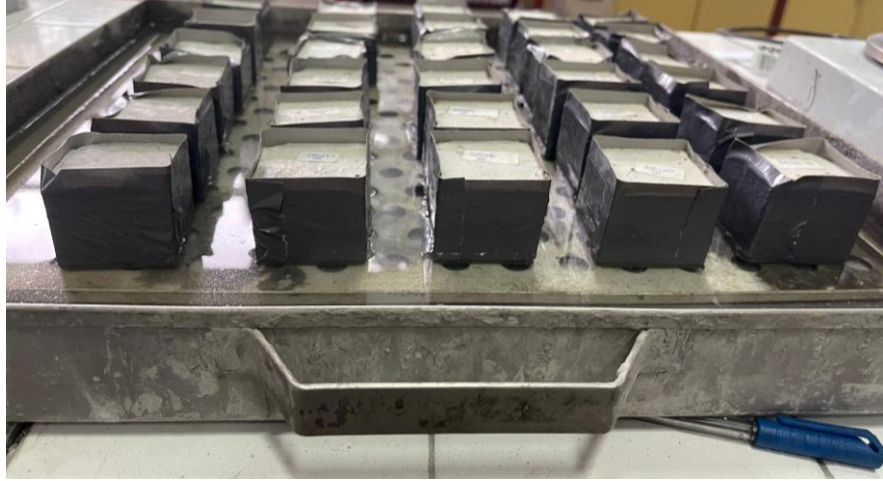
Şekil 4.13. Yan yüzeyleri izole edilmiş numunelerin su emmesi
