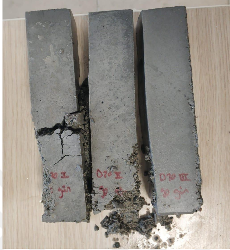
Şekil 4.17. Donma-çözülme döngüleri sonrası numunelerin yakından görünümü
