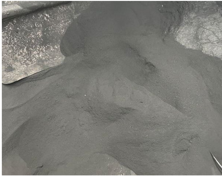
Şekil 2.3. Piroliz işlemi sonucunda elde edilen karbon tozları.
