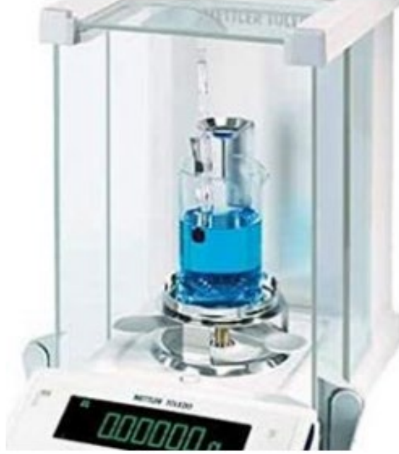
Şekil 2.9. Mettler Toledo yoğunluk ölçme kiti.
