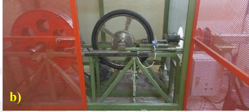
Şekil 2.18 Yol mukavemet test cihazı üstten görseli b) Yandan görseli.
