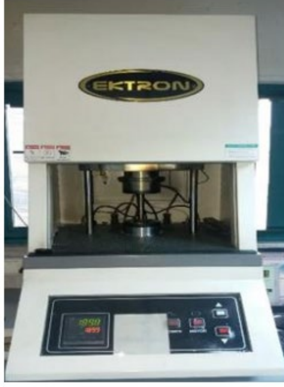
Şekil 2.11. EKTRON MDR 2000S- reometre test cihazı.
