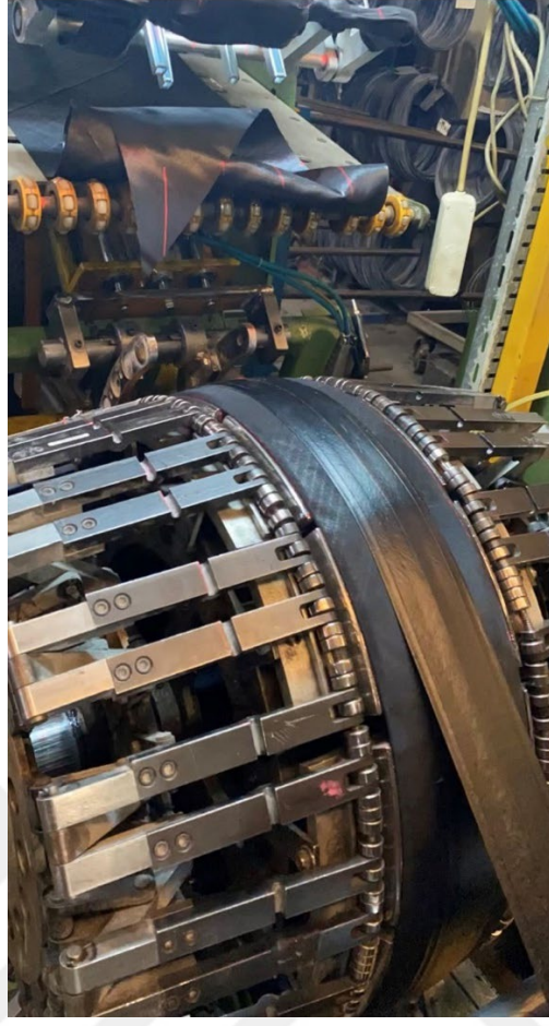
Şekil 1.5. Bisiklet lastiği yapım aşaması.
