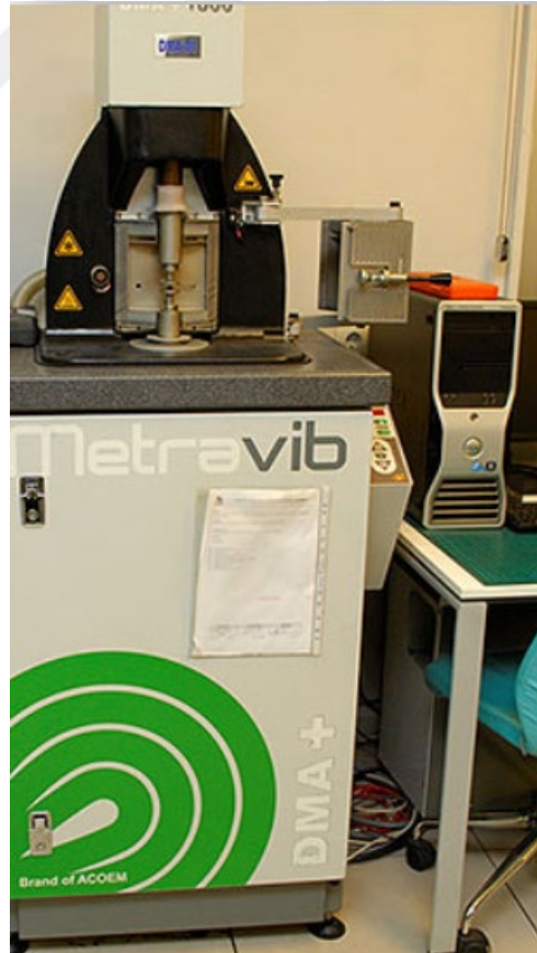
Şekil 2.16. Payne etkisinin incelendiği METRAVIB DMA +1000 cihazı.
