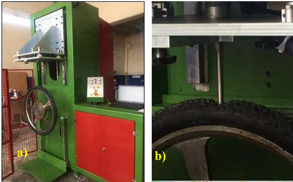
Şekil 2.17. a) Plunger test cihazı b) Test anından görsel.
