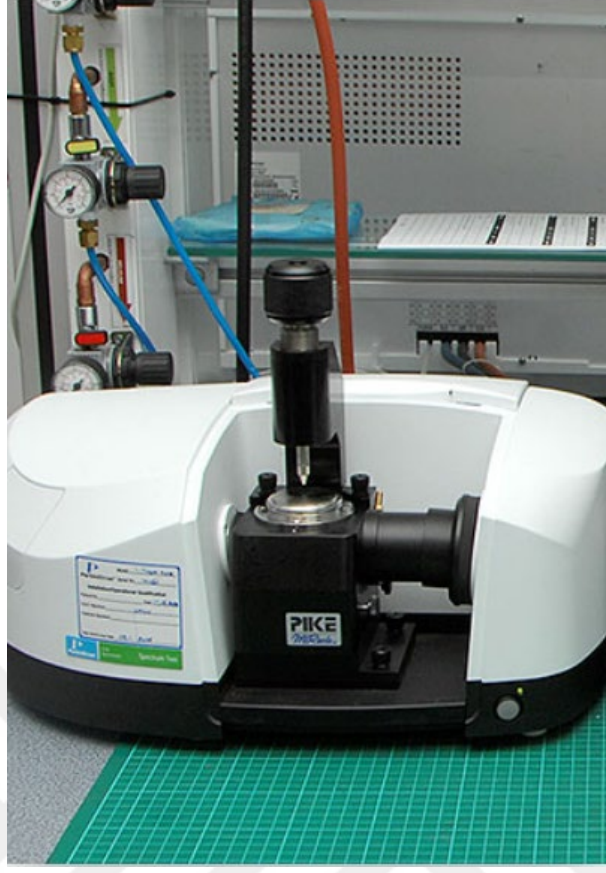
Şekil 2.15. FTIR analizlerinin yapıldığı cihaz.
