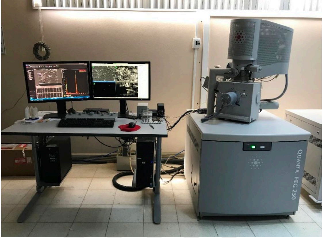
Şekil 2.13. SEM- EDS cihazı.
