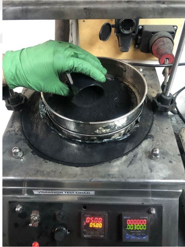
Şekil 2.6. FK’ye ait 325 mesh elek testi uygulaması.
