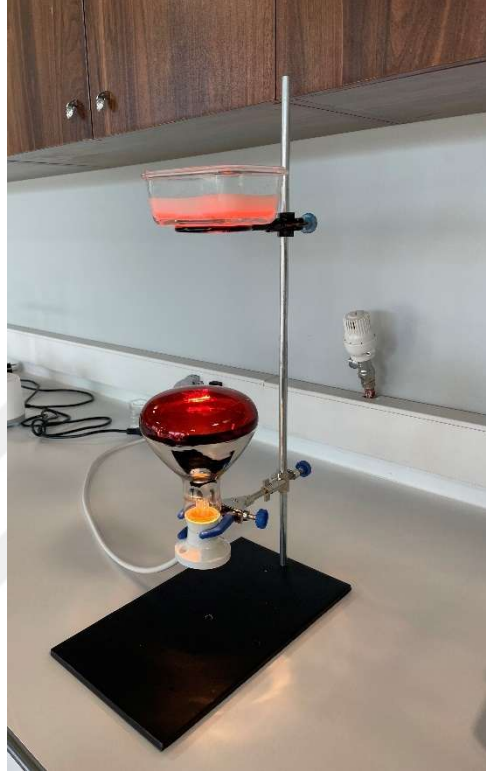
Şekil 3.1. Kızılötesi lamba ile kurutma düzeneği
