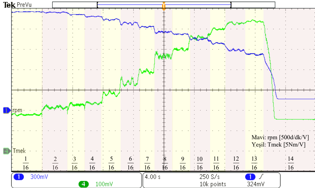
Şekil 6.18. 6m/s rüzgar hızında D değerinin değişimine göre generatör hız ve moment eğrileri.
