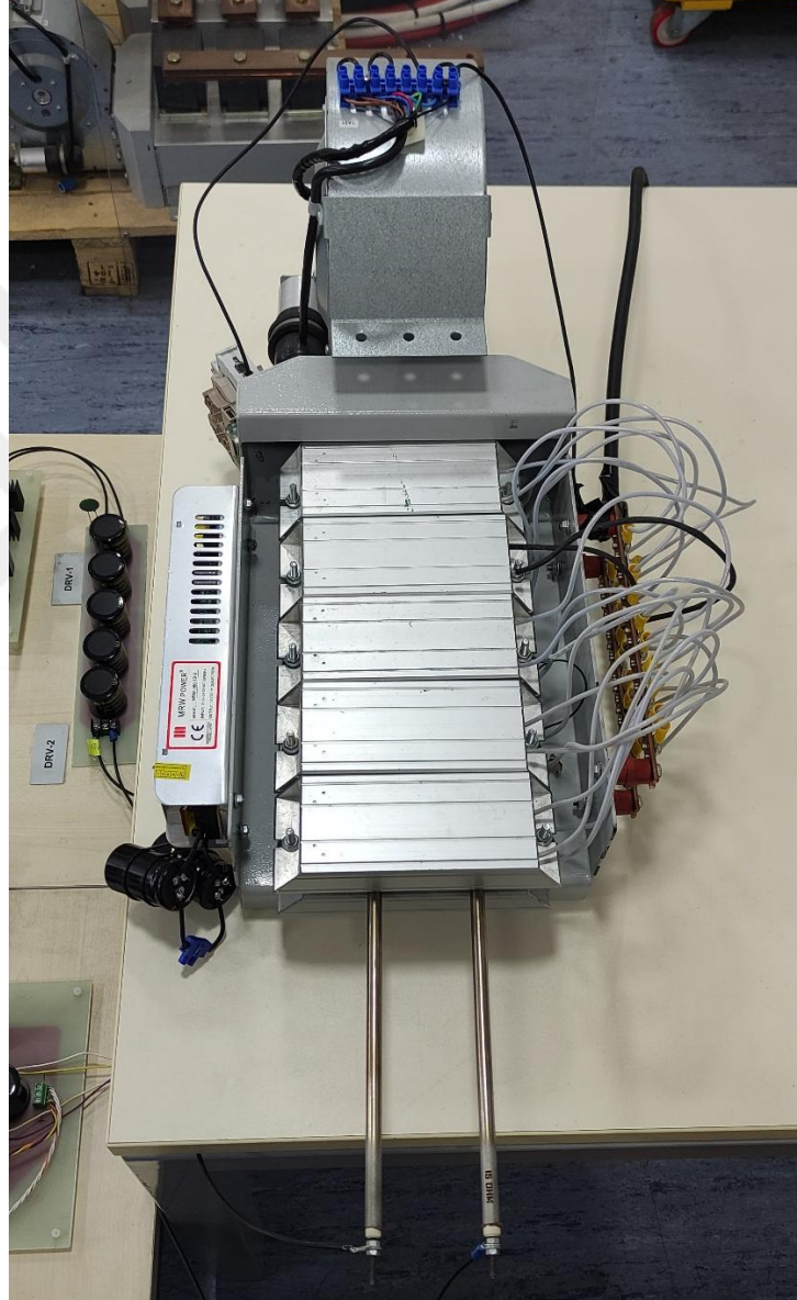
Şekil 6.7. U direnç ve soğutma ünitesi.
