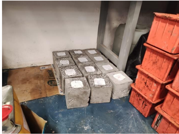
Şekil 7. Deneylerde kullanılmak üzere hazırlanmış kürleme işlemleri bitmiş beton numuneleri
