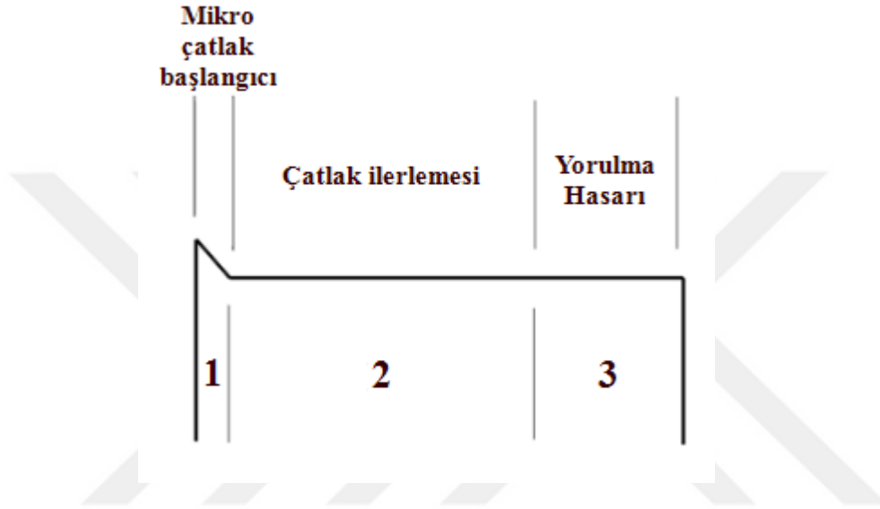
Şekil 2.2: Yorulma hasarı aşamaları
