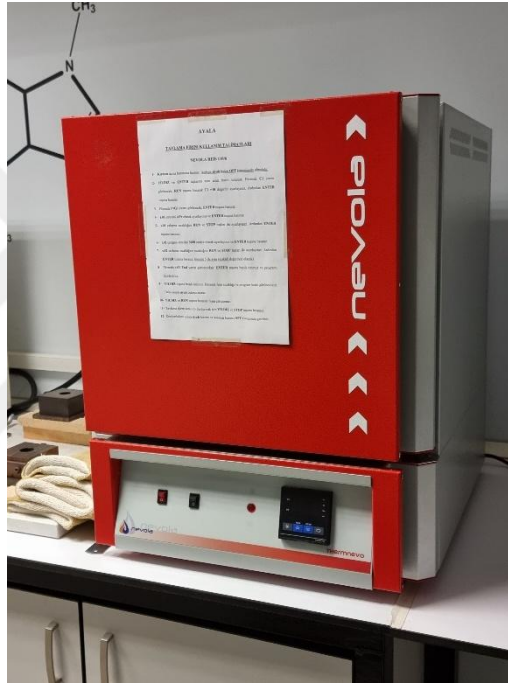
Şekil 3.3. Tavlama fırını (1100°C)
