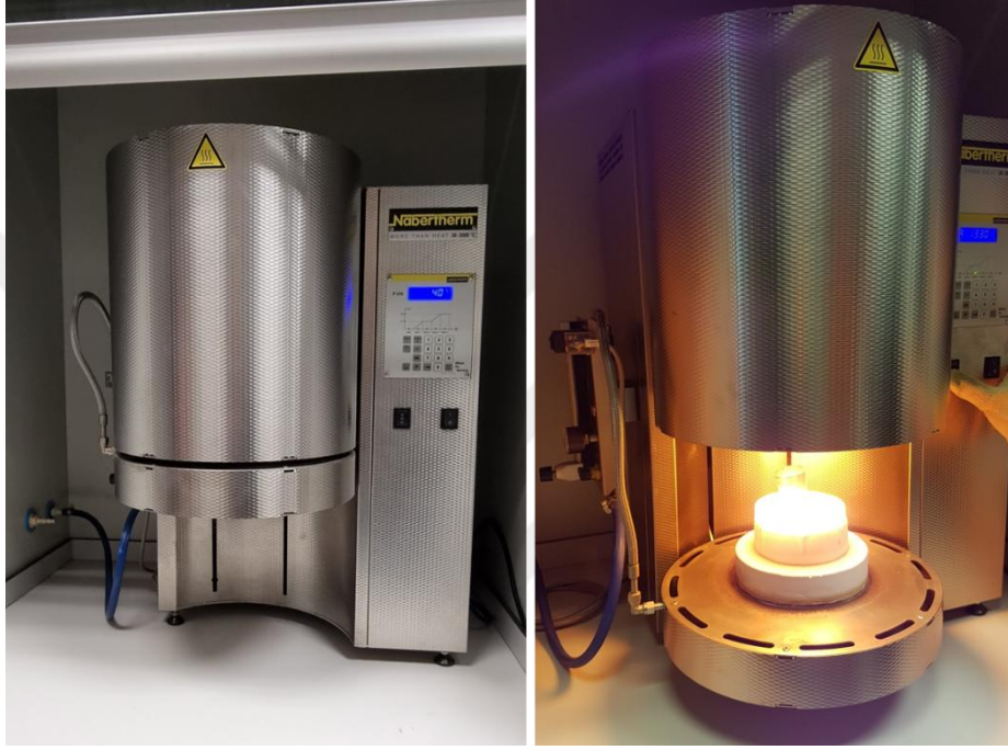
Şekil 3.2. Yüksek sıcaklık fırını (1700°C)
