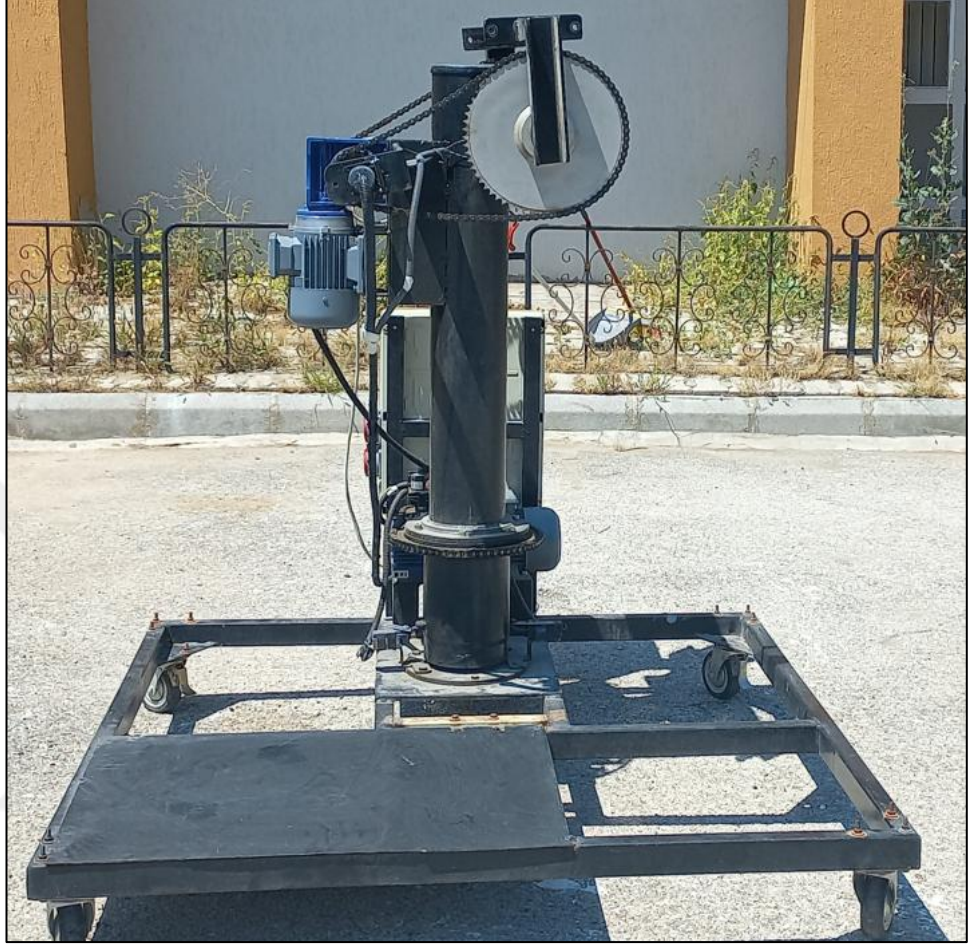
Şekil 3.31. Parabolik çanak kolektör temel destek yapısı
