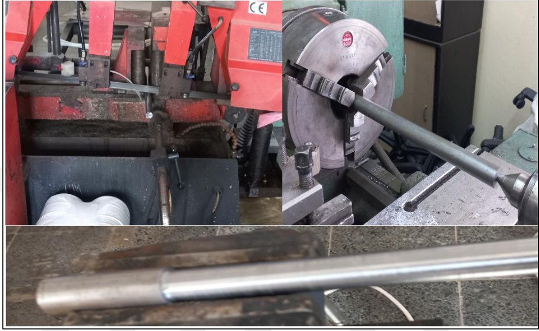
Şekil 3.16. Motor mil çeliği imalat aşamaları
