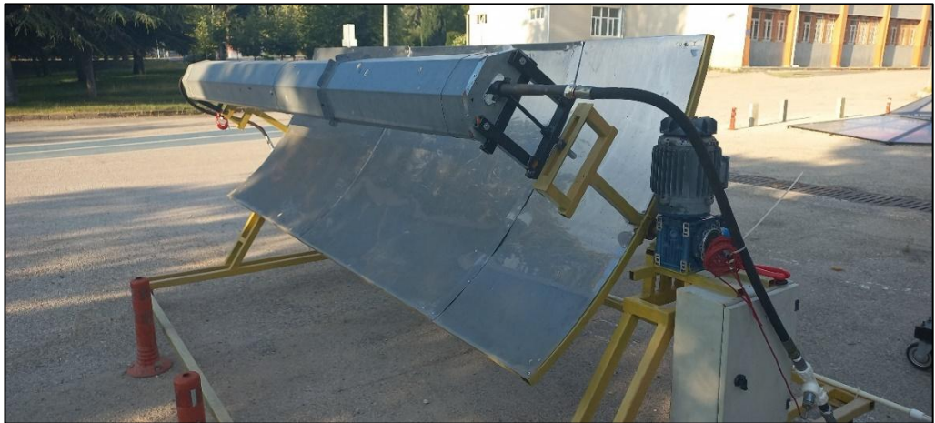
Şekil 3.20. Tasarlanan parabolik oluk kolektör sistemi
