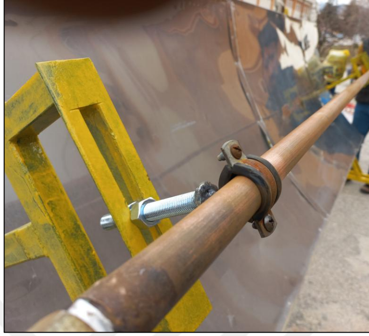
Şekil 3.19. Parabolik oluk kolektör alıcı ve sabitleme kolu
