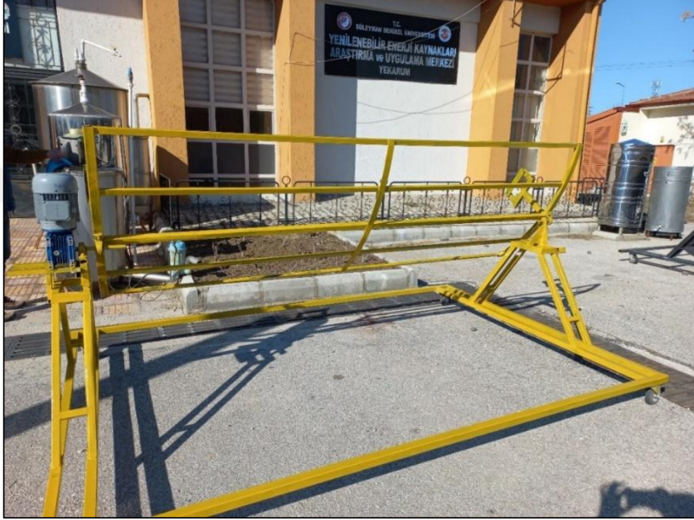
Şekil 3.18. Parabolik oluk kolektör temel yapısı
