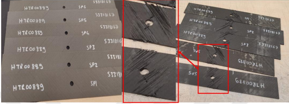
Şekil 6.15 DÇT deneyi numuneleri ve deney sonrası numune kırılması.
