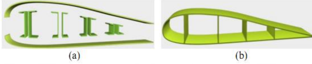
Şekil 3.7 a) Geleneksel kompozit üretimi b) Net şekilli kompozit üretimi
