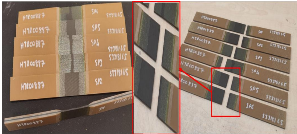
Şekil 6.6 ÇÇT deneyi numuneleri ve deney sonrası numune kırılması.
