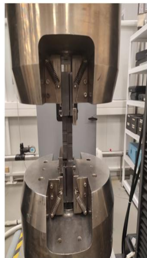
Şekil 6.16 Delikli basma testi; a) Test düzeneği b) Test plaka boyutları
