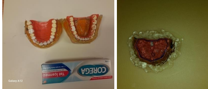
Şekil 30 Oral Kavite Katı Fantom Düzenegi
