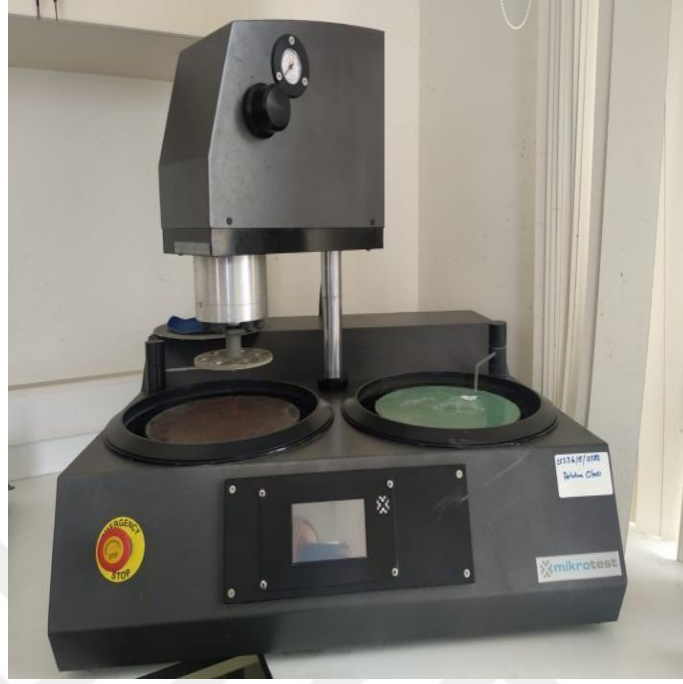
Şekil 3.4. Zımparalama ve parlatma cihazı
