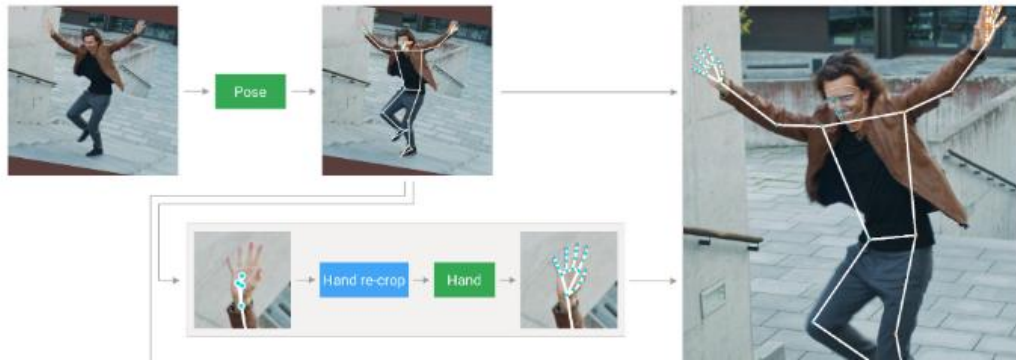
Şekil 3.7 MediaPipe Holistic Çalışma Yöntemi (Ivan vd., 2020)
