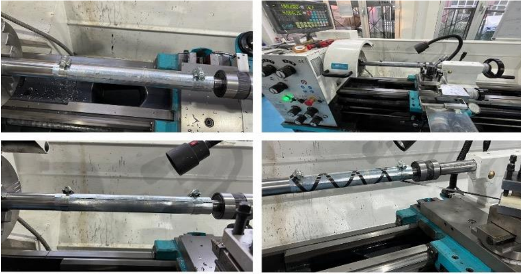
Resim 7.10. Tek yönlü PEEK/CF malzemesinin mandrel üzerine sarımı
