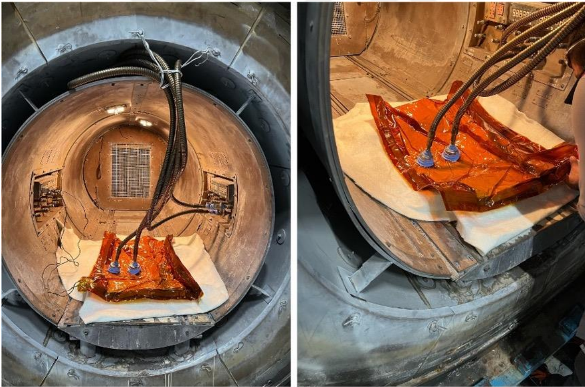
Resim 7.15. Numunenin otoklav yerleşimi ve port bağlantıları
