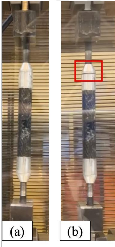
Resim 8.53. İkinci tasarım çözümü ve EA9396 yapıştırıcısı kullanılarak üretilen numunelerin çekme testi öncesi (a) ve sırasında (b) numune geometrisi
