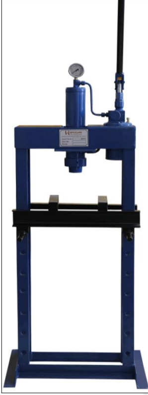
Resim 7.24. Deneysel birleştirme uygulamasında kullanılan hidrolik presleme fikstürü
