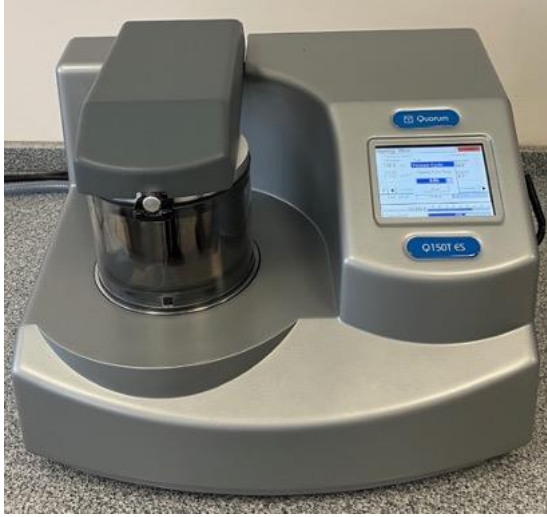
Resim 7.44. Karbon kaplama işlemi için kullanılan Quorum Q150T ES cihazı
