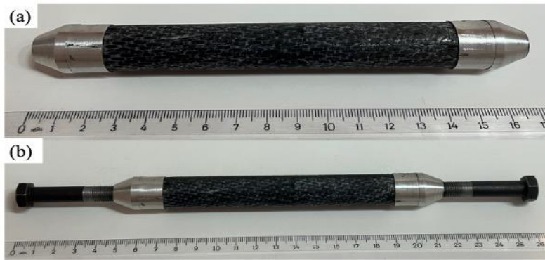
Resim 7.35. Çekme testi için hazırlanan komponentin nihai formu (a) ve test fikstürü bağlantısı için civata takılmış hali (b)
