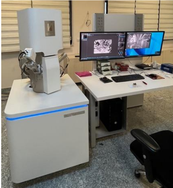
Resim 7.45. SEM görüntülemesinde kullanılan TESCAN MIRA cihazının genel görünümü
