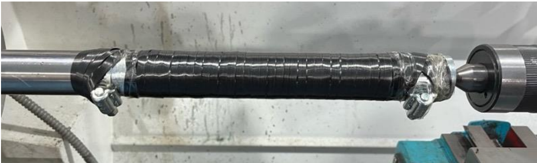
Resim 7.11. PEEK/CF malzemesinin tek katman olarak sarıldığı numune
