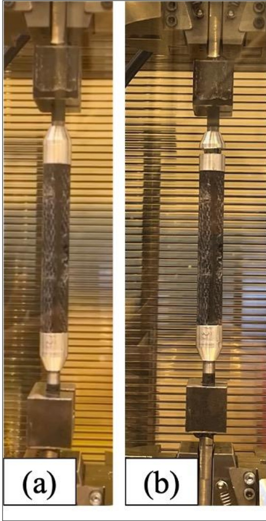
Resim 8.47. Çekme testi öncesi (a) ve sırasında (b) numune görüntüsü
