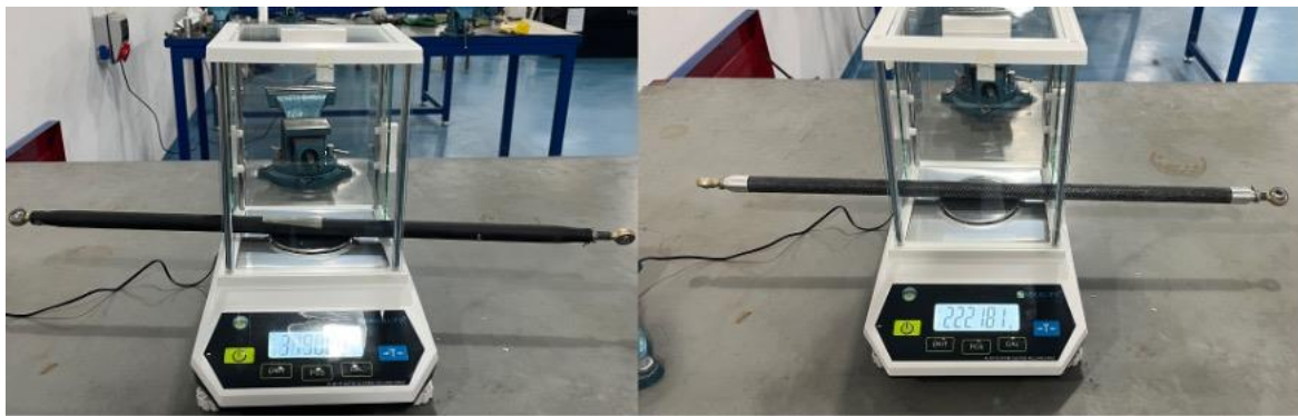
Resim 8.54. Muadil ve TPK kontrol rodu kütle ölçümleri
