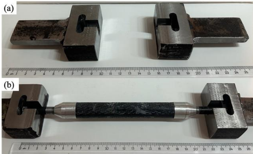
Resim 7.36. Çekme testi için tasarlanmış çelik adaptör parçalar (a) ve komponent numunenin adaptörlere monte edilmiş hali (b)
