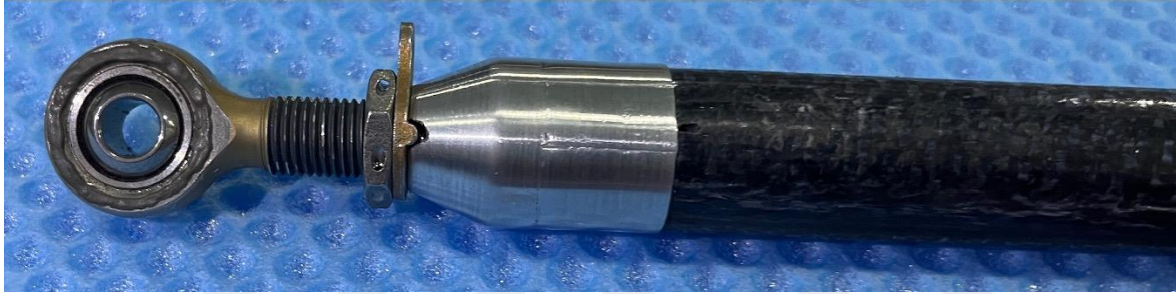
Resim 8.43. Montajı tamamlanmış TPK Kontrol Rod Parçası – birleştirme bölgesi detay görüntüsü
