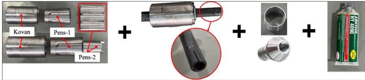
Resim 7.26. Kullanılan üç parçalı kalıp sistemi (Pens-1, Pens-2, Kovan), metal insört, yüzük elemanı ve yapıştırıcı
