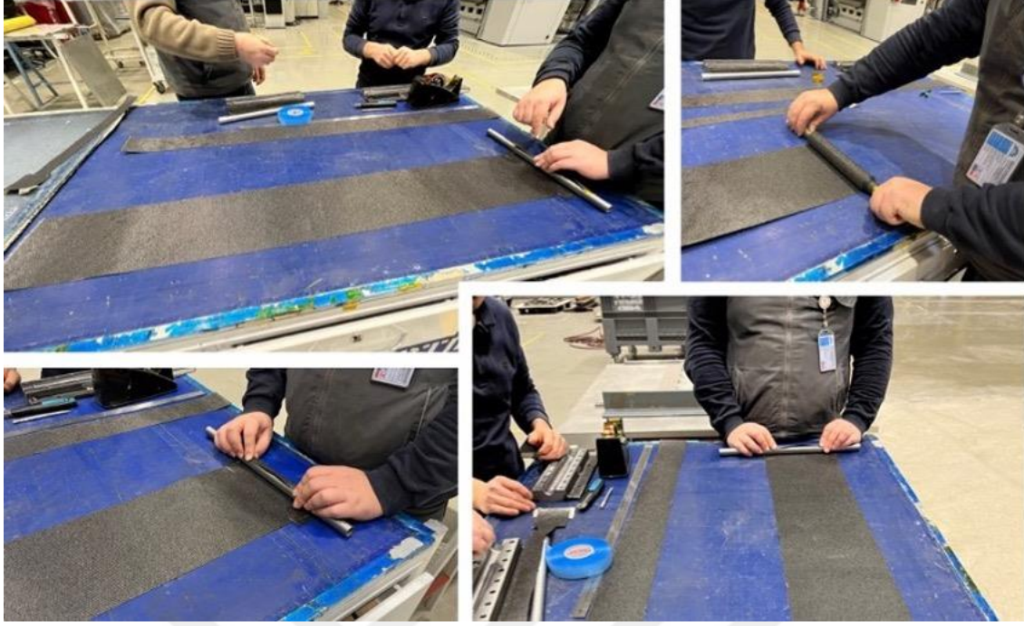
Resim 7.16. Kumaş malzemenin mandrel üzerine sarılması
