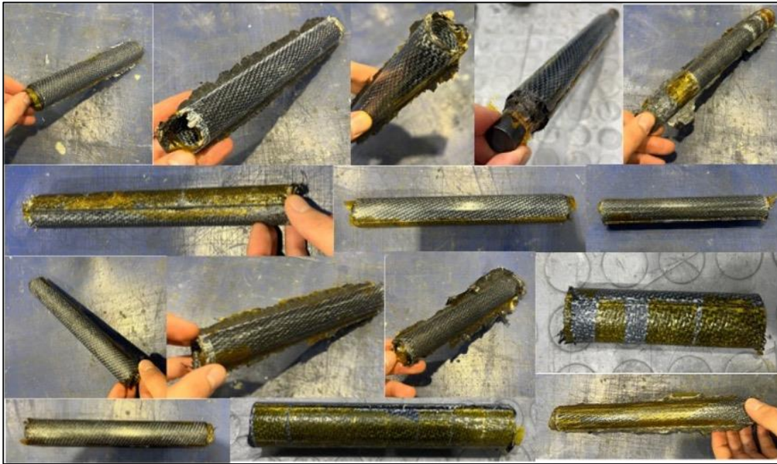
Resim 8.4. Taguchi L16 deney tasarımına göre sıcak pres kalıplama üretilen kupon numunelere ait tüp şekilli kompozit yapıların genel görünümü
