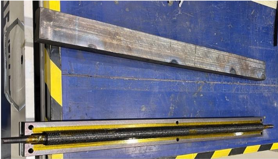
Resim 7.21. Sarımı tamamlanan numunenin kalıp içerisine yerleştirilmiş hali
