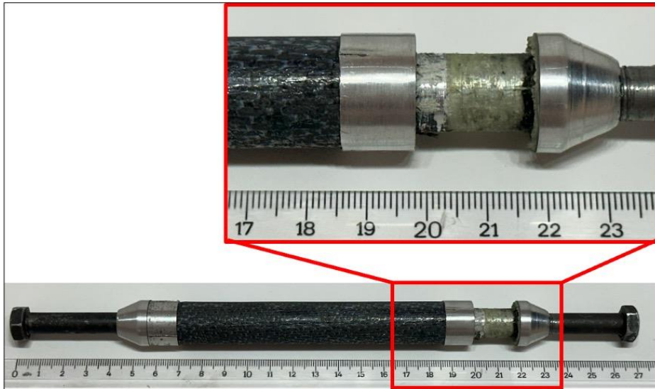
Resim 8.48. Çekme testi sonrası birleşme bölgesinin görünümü
