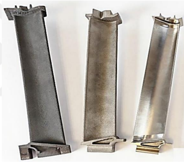
Şekil 1.19. EB-PBF ile üretilmiş TiAl türbin bıçakları [54]
