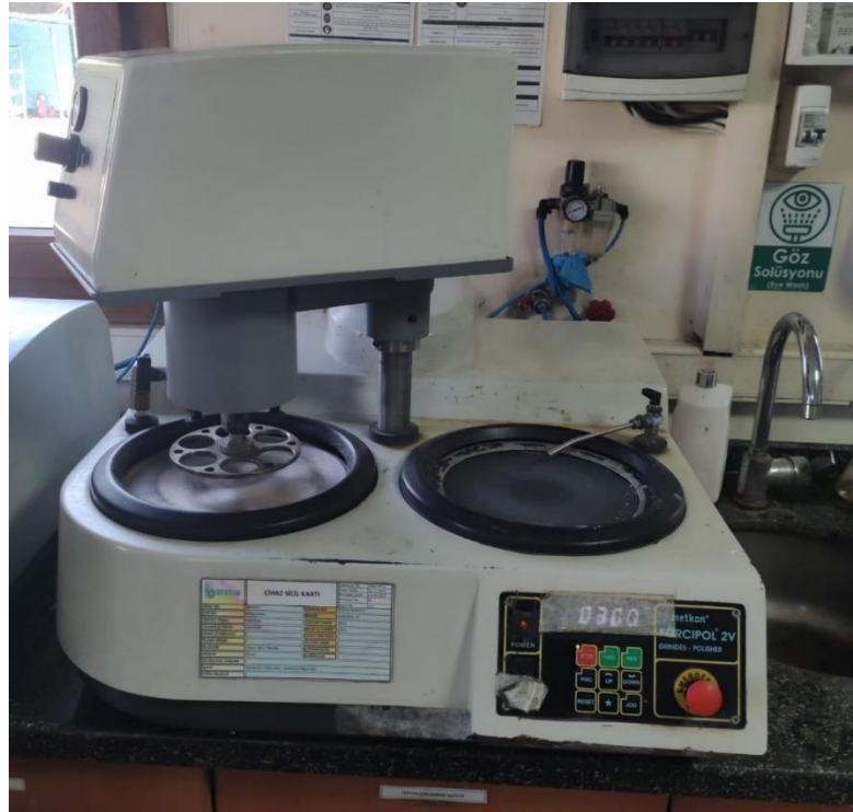
Şekil 3.19. Metkon Marka Zımparalama ve Parlatma Test Cihazı
