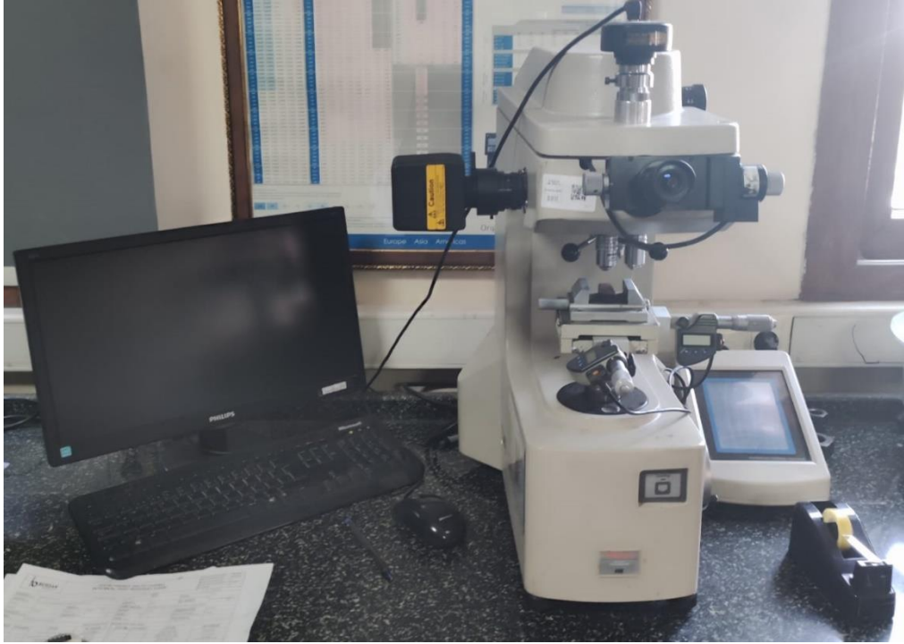
Şekil 3.20. MITUTOYO Marka Vickers Sertlik Cihazı
