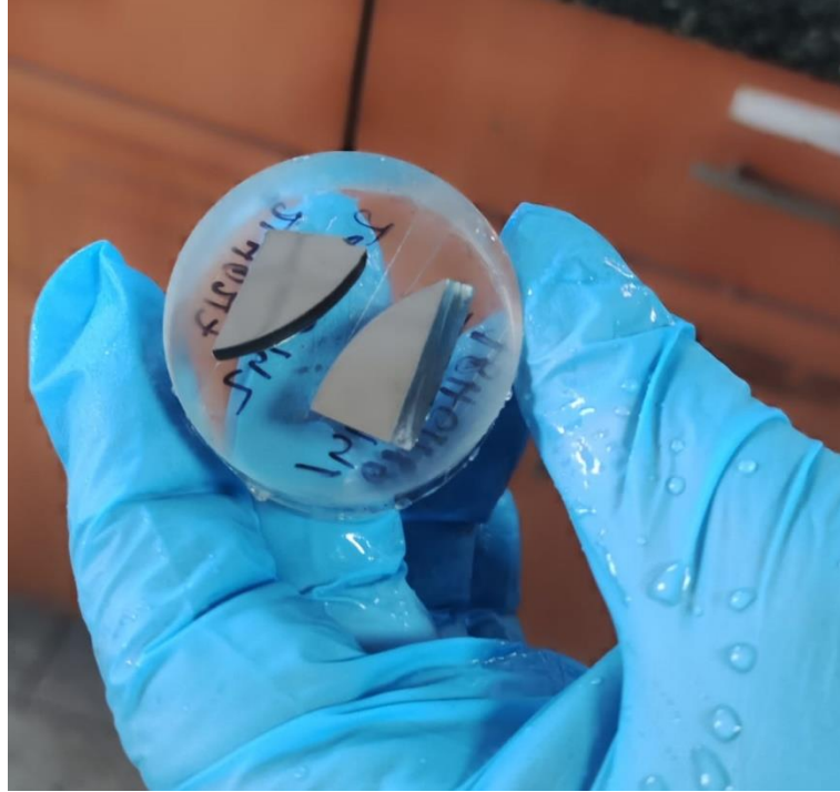
Őekil 3.22. Dađlama İřlemi Görmüş Numune
