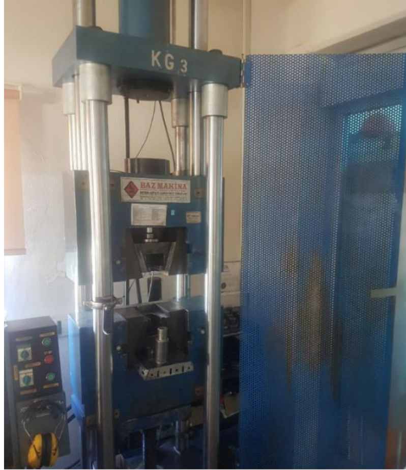
Şekil 3.8. BAZ marka 60 Tonluk Çekme Cihazı
