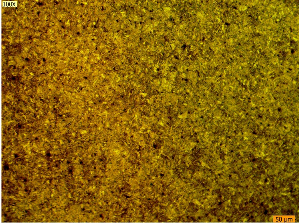
Şekil 4.10. 435°C de Meneviş Yapılmış 33MnCrB5 Çeliğinin Mikro Yapısı
