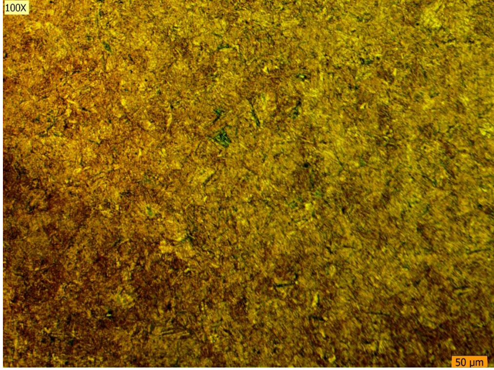
Şekil 4.18. 465°C de Meneviş Yapılmış 30MnCrB4-2 Çeliğinin Mikro Yapısı
