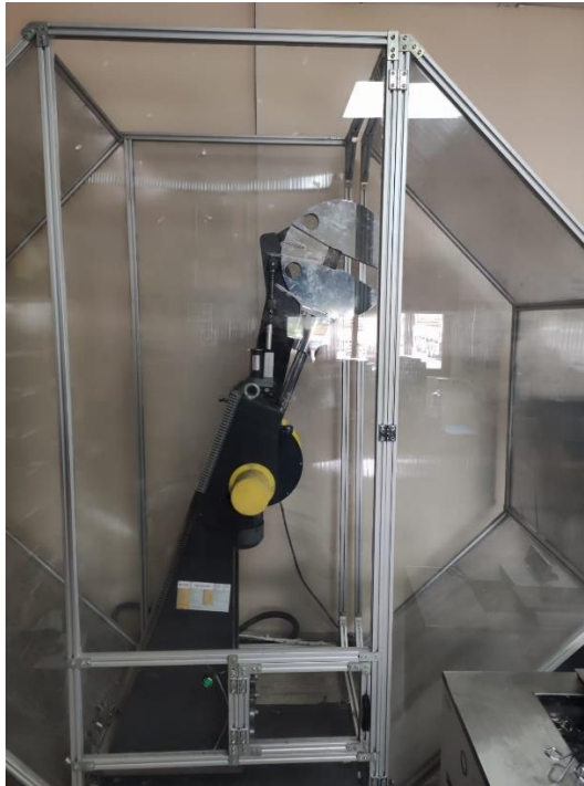
Şekil 3.12. Deneyde Kullanılan Çentik Darbe Test Cihazı
